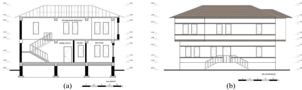
Şekil 3.23. a) ÇŞİDB Erzurum yöresel konut projesi AA kesiti, b) ÇŞİDB Erzurum yöresel konut projesi ön görünüşü.
