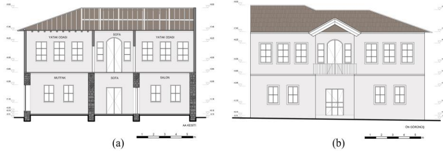
Şekil 3.13. a) Konak AA kesiti, b) Konak ön görünüşü.
