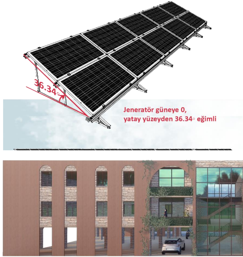
Şekil 5.19. Musul şehri için uygun panel açısı.
