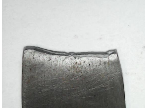
Şekil 6.46. Kırılma görüntüsü DP600 LW.
