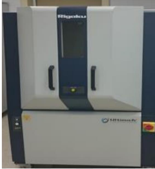
Şekil 5.11. KBÜ MARGEM Rigaku marka XRD test cihazı.
