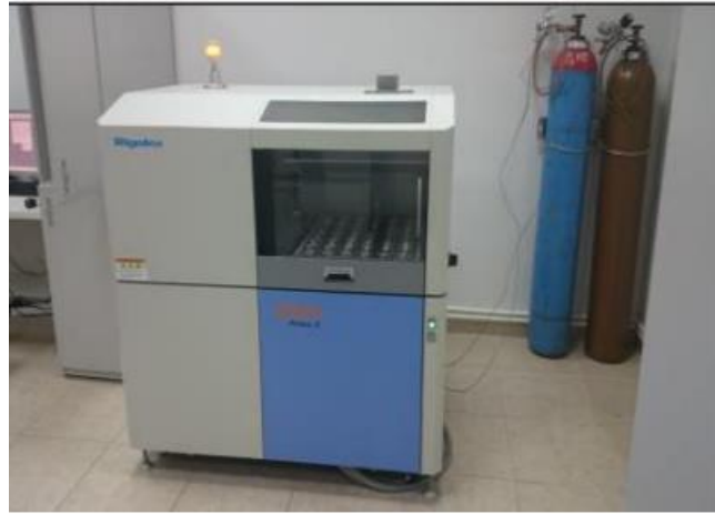
Şekil 5.10. KBÜ MARGEM Rigaku Primus II X-Ray Floresans Spektrometresi test cihazı.
