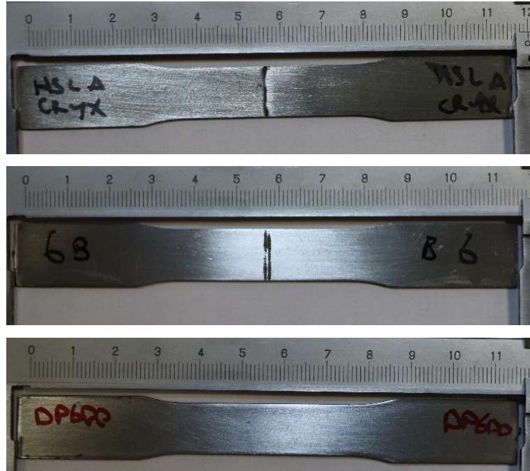
Şekil 6.35. Çekme testi öncesi bazı numunelere ait uzunluk ölçüm görselleri.
