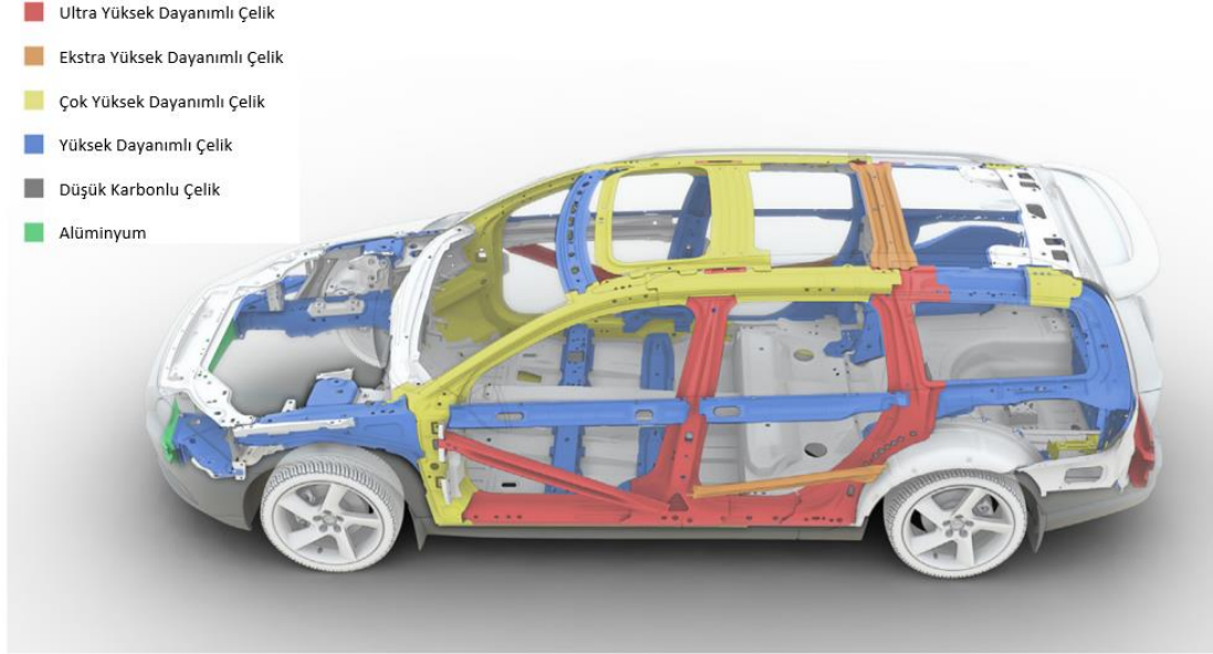
Şekil 2.4. Otomotiv gövdesinde kullanılan malzemelerin gövde üzerindeki kullanım alanı gösteren görsel [41].
