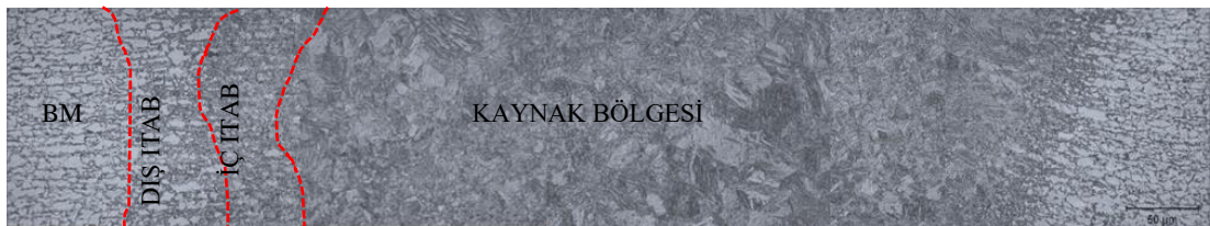
Şekil 6.12. DP600 kaynaklı kriyojenik işlemsiz numuneye ait 500X büyütmeli mikroyapı görsellerinin birleştirilmiş görüntüsü.
