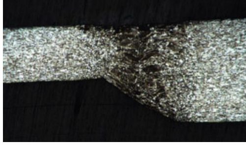
Şekil 3.10. Nd:YAG lazer kaynaklı TWB mikrogörüntüsü [163].
