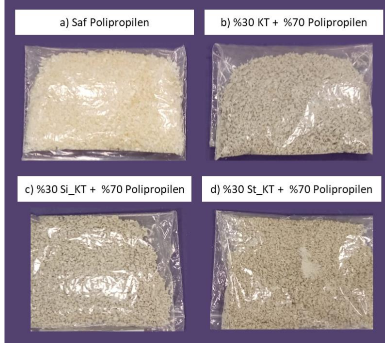
Şekil 4.3. Karıştırma işlemi sonucu elde edilen numuneler: a) PP, b) %30 KT + %70 PP, c) %30 Si_KT + %70 PP, d) %30 St_KT + %70 PP.
