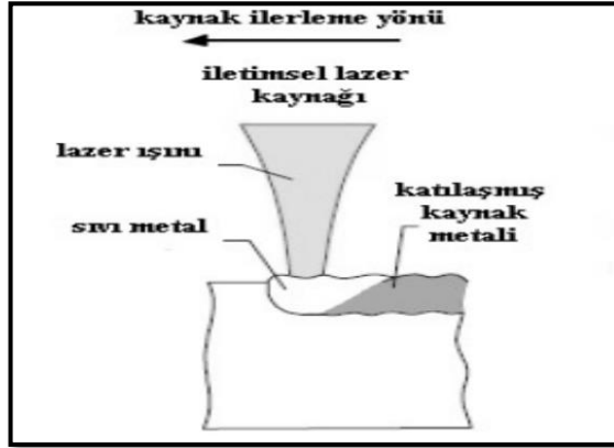
Şekil 3.4. İletimsel lazer kaynağının şematik gösterimi [52].
