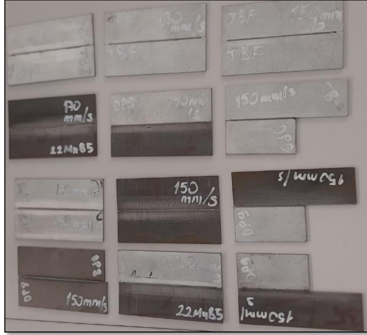
Şekil 5.2. Kaynak işlemi ardından numuneler.
