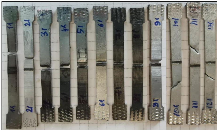
Şekil 6.22. Çekme testi sonrasında kaynaklı numune görselleri
