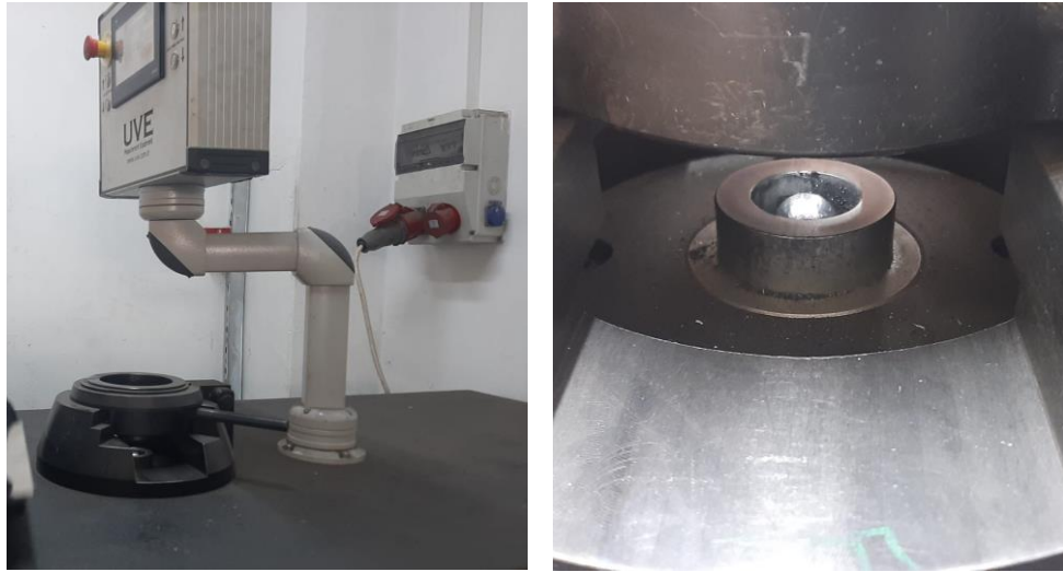
Şekil 5.8. Erichsen çökertme testinin yapıldığı cihaz ve kalıbı.
