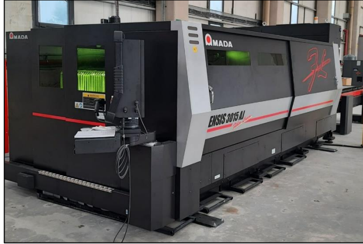
Şekil 5.3. Numune kesimlerinin gerçekleştirildiği lazer cihazı.
