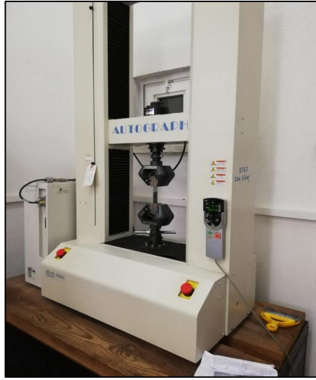
Şekil 5.7. Çekme testinin yapıldığı cihaz.
