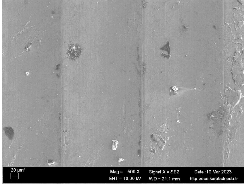
Şekil 5.5. İşlenmiş yüzey SEM görüntüsü (Kuru, V=350 m/dk, f=0.40 mm/dev).
