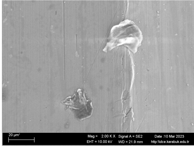
Şekil 5.7. İşlenmiş yüzey SEM görüntüsü (Kuru, V=350 m/dk, f=0.40 mm/dev).
