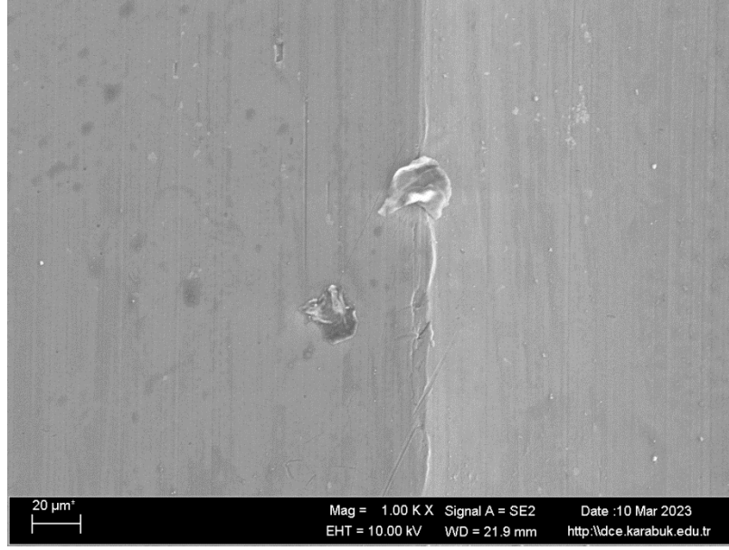
Şekil 5.6. İşlenmiş yüzey SEM görüntüsü ( Kuru, V=350 m/dk, f=0.40 mm/dev).
