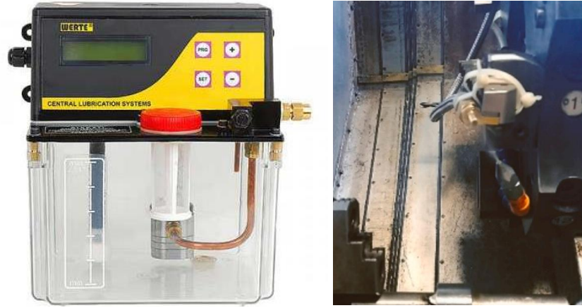
Şekil 4.5. Werte StN 15 MQL sistemi ve nozul kısmı.
