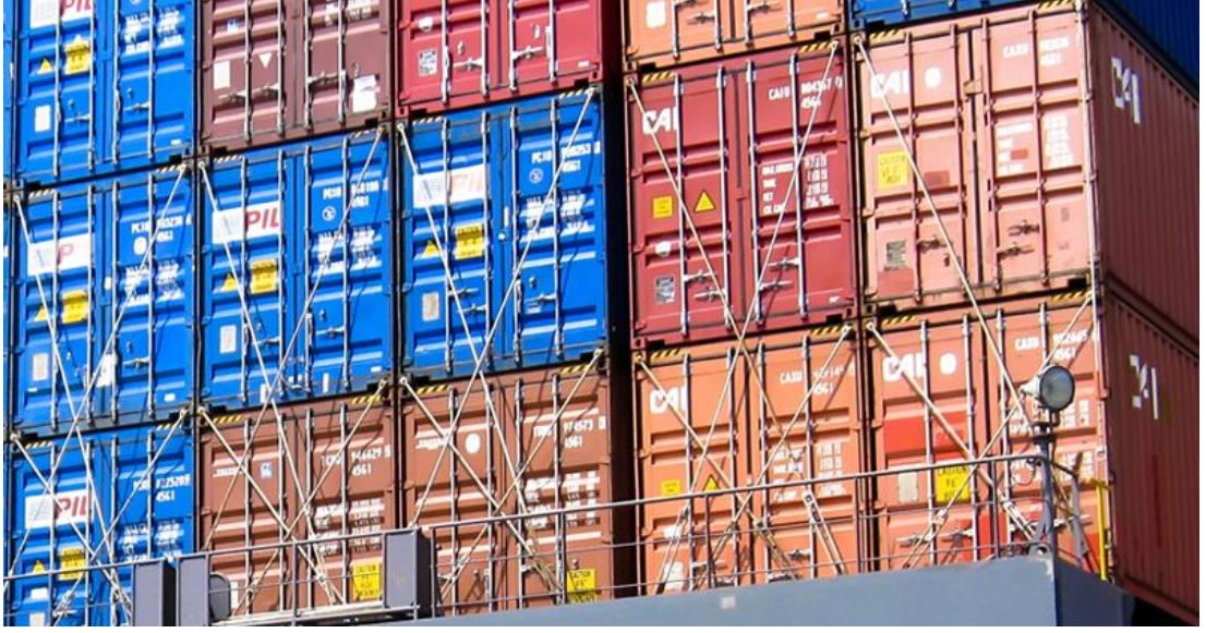
Şekil 4.16. Güverte üzerinde konteynırların bağlanması [50].
