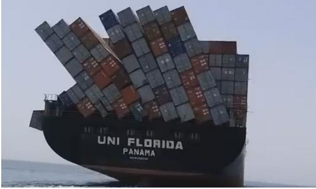
Şekil 4.17. Güverte üzerinde konteynır yığınının devrilmesi [51].
