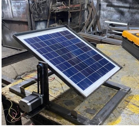
Şekil 5. 11.Taşıyıcı sistem imalatı.
