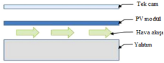
Şekil 3.11. Havalı PV/T kolektörünün sistemi.
