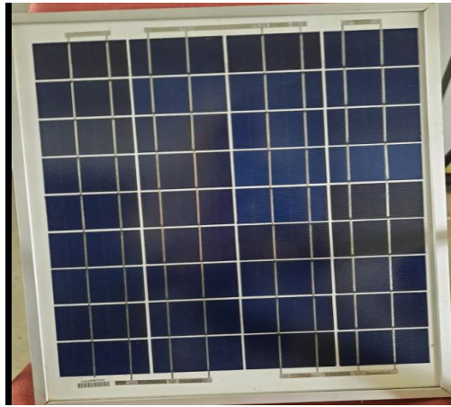
Şekil 3.6. Polikristal fotovoltaik (PV) panel
