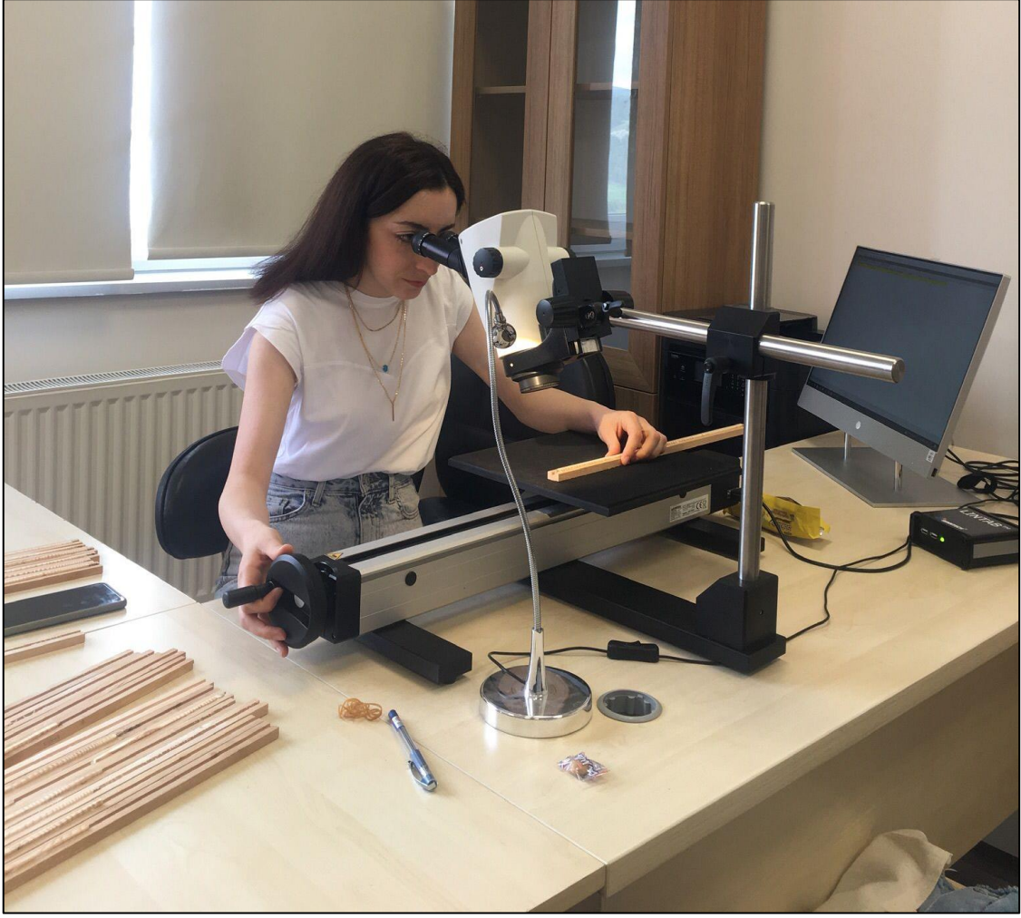
Fotoğraf 7: Yıllık halka genişliklerinin LİNTAB-TSAP programında ölçüm aşaması (Örnekler Karabük Üniversitesi Coğrafya Bölümü Dendrokronoloji Laboratuvarında ölçülmüştür).
