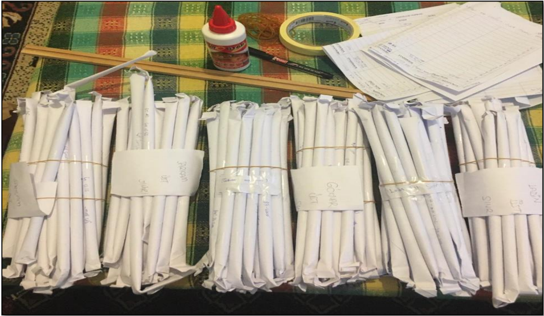
Fotoğraf 2: Alınan örneklerin (sarıçam, gökmar, ladin) kağıt taşıyıcılardaki görselleri (Kağıt taşıyıcılar örneklerin arazide zarar görmesini engeller ve laboratuvar ortamına güvende gelmesini sağlar).
