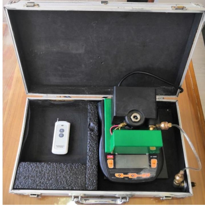
Çizelge Ek A.1. Soğutucu akışkan şarjı ve tartı mekanizması.
