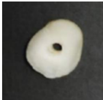
Şekil 5.4 Metalografik işlemlerin ardından çıkarılan dentin disk
