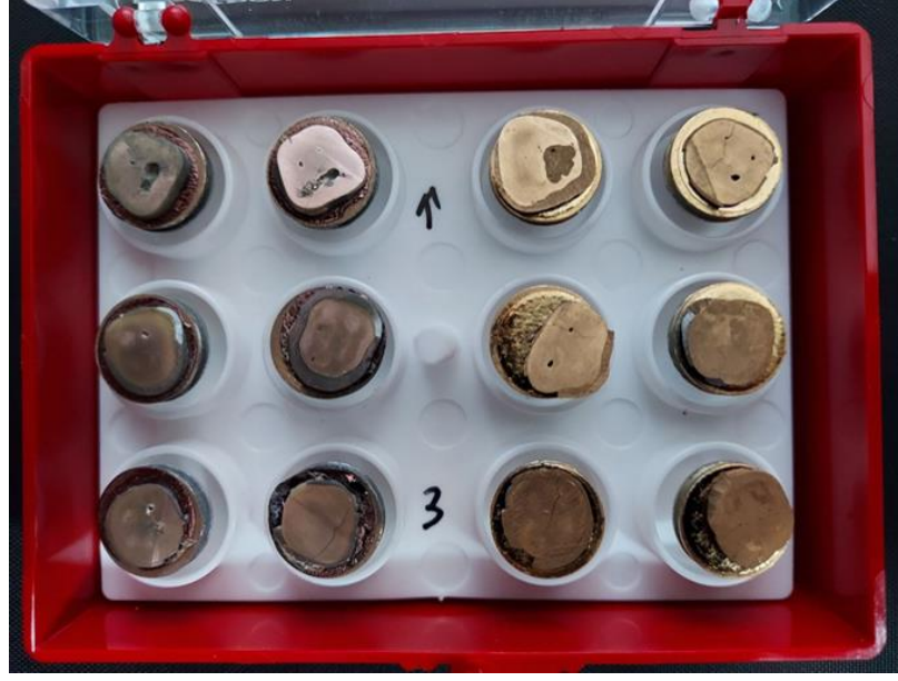
Şekil 5.6 Kaplama yapıldıktan sonra dentin disklerin görüntüsü
