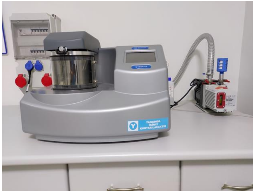
Şekil 5.5 Q150R Rotary-Pumped sputter coater (kaplama cihazı)
