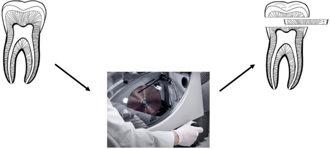
Şekil 5.1 Dentin disklerin Struers Secotom – 50 kesme cihazı ile dişten çıkarılması
