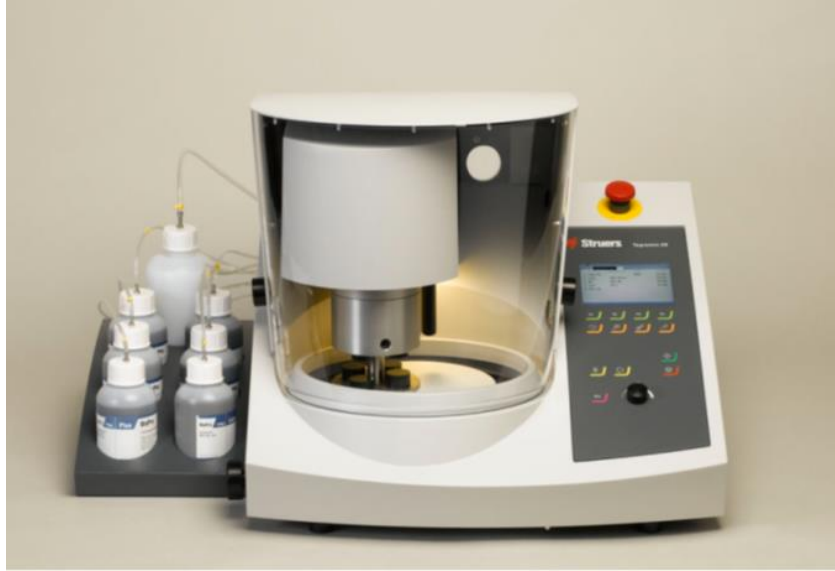
Şekil 5.2 Struers Tegramin-30 zımparalama ve parlatma cihazı
