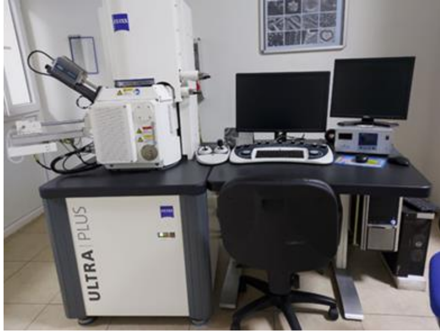
Şekil 5.7 Carl Zeiss Ultra Plus Gemini FE-SEM cihazı
