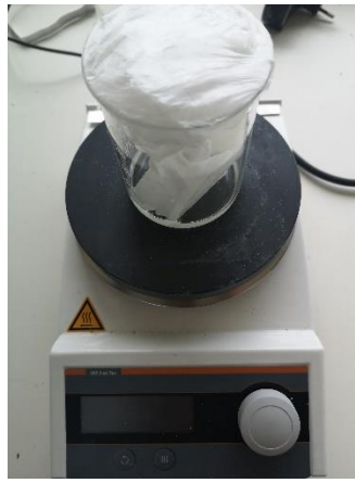
Şekil 4.2. Plakalı ısıtıcı ve karıştırıcı ve nano-FDM numunesi
