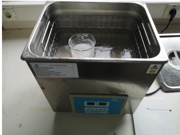
Şekil 4.3. Ultrasonik banyoda nano-FDM numunesi hazırlanması
