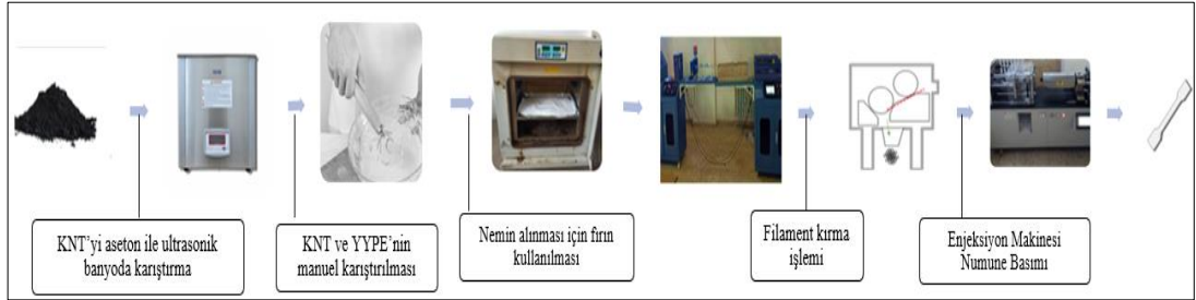
Şekil 5. 4. Aseton ile karıştırma yöntemiyle KNT ile YYPE numunelerinin üretimi
