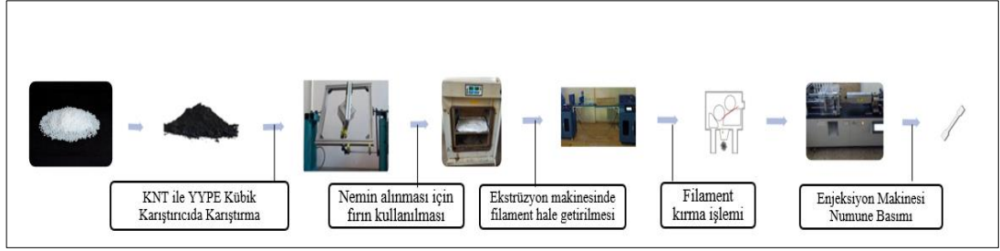
Şekil 5. 3. Kübik karıştırıcı yöntemiyle KNT ile YYPE numunelerinin üretim aşaması
