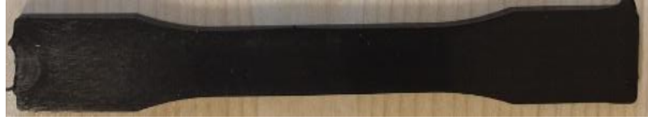
Şekil 5. 13. ASTM D638 TYPE I standartlarına göre çekme numunesi
