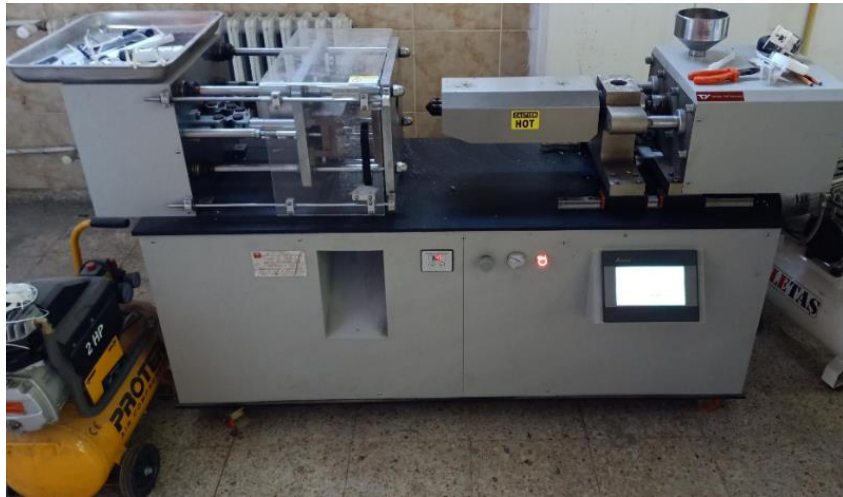
Şekil 5. 12. Plastik enjeksiyon çekme testi numunelerinin alınması
