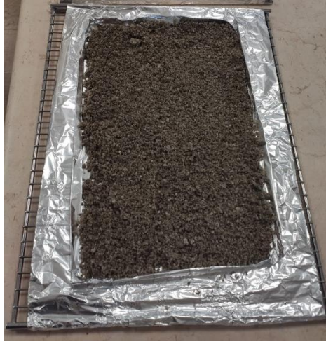
Şekil 6.2. Yüksek fırın cürufu kurutma işlemi.
