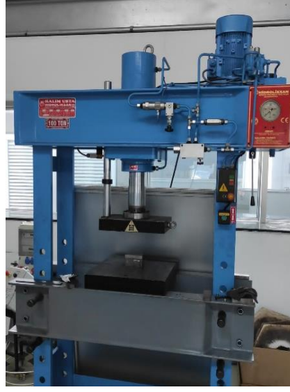
Şekil 3.3. 100 Tonluk Soğuk Pres Makinası.
