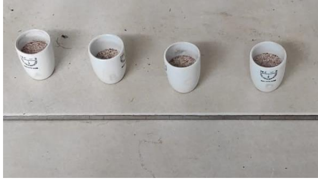
Şekil 3.7. Oda Sıcaklığında Silis Kumu İçerisinde Soğuması Beklenen Numuneler
