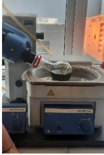
Şekil 5.3. Ekstrelerin Rotary Evaporatörde Yoğunlaştırılması
