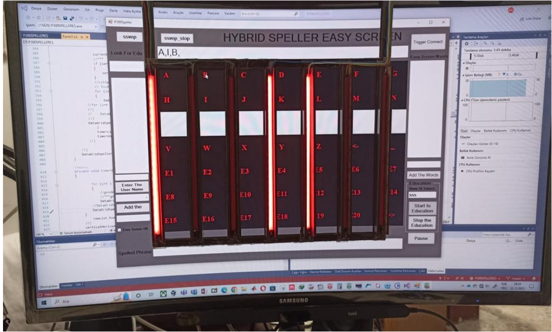
Şekil 5.1. P300 OİP- DHGUP kaynaklı hibrit heceleyici. Monitörde gösterilen program P300 OİP elde etmek için, monitöre monte edilmiş olan şerit LED'li donanım ise DHGUP elde etmek için kullanılmaktadır.
