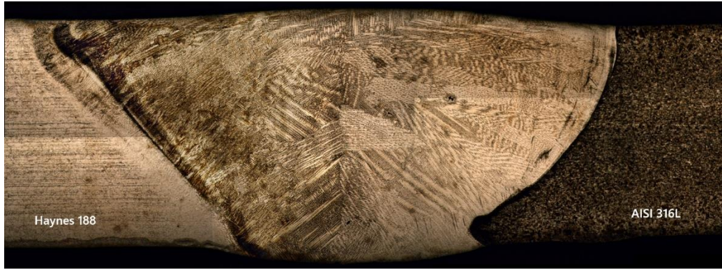
Şekil 6.2. Haynes 188-AISI 316L farklı cins kaynaklı birleşirme makroyapı profili görüntüsü.
