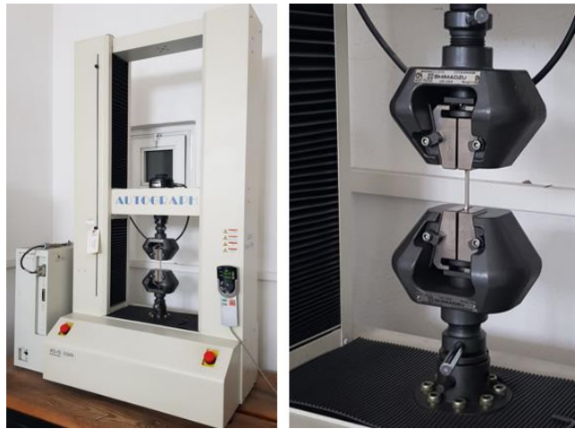
Şekil 3.5. Çekme test cihazı ve deney yapılan numune.
