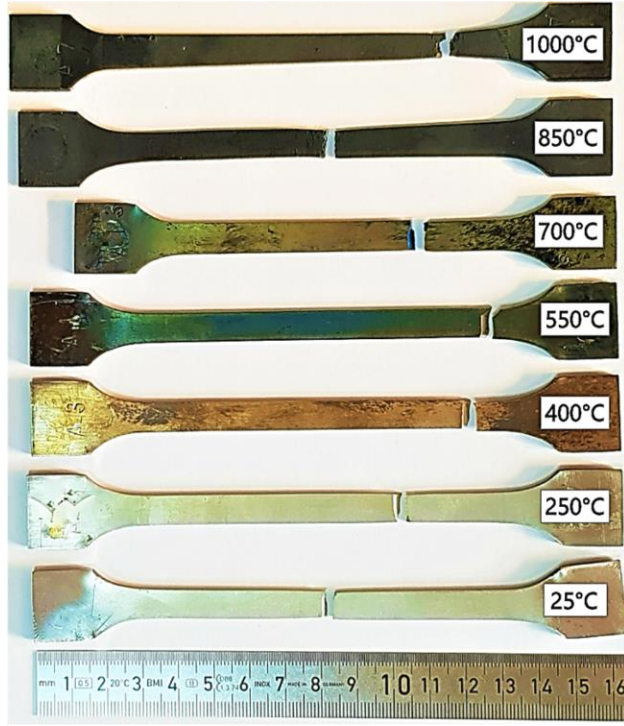
Şekil 4.11. Haynes 188 süper alaşım malzemenin sıcak çekme testi sonrası numune görüntüleri.
