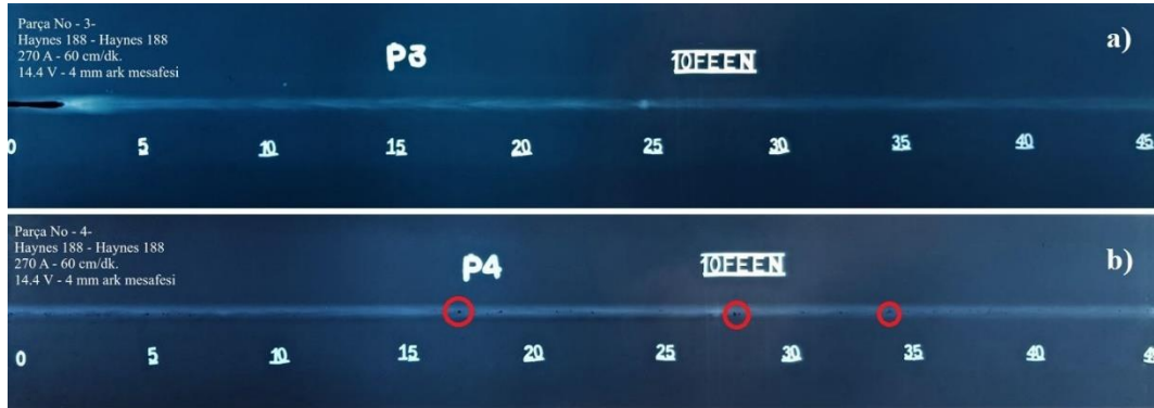
Şekil 5.1. Kaynaklı Haynes 188 numunelerin X-Ray radyografik muayene görüntüsü.
