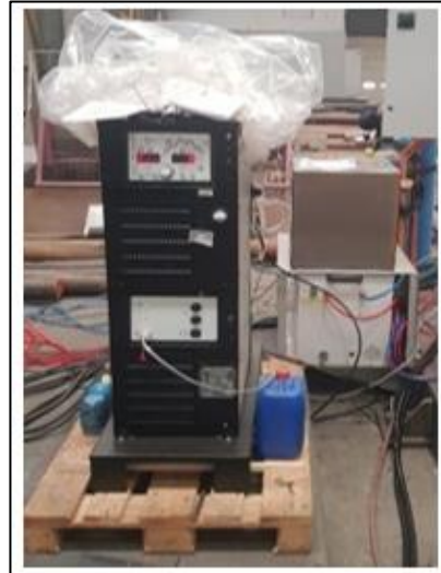
Şekil 3.18. EWM marka FT 1002 Force TIG model TIG kaynak makinesi ve soğutma ünitesi.
