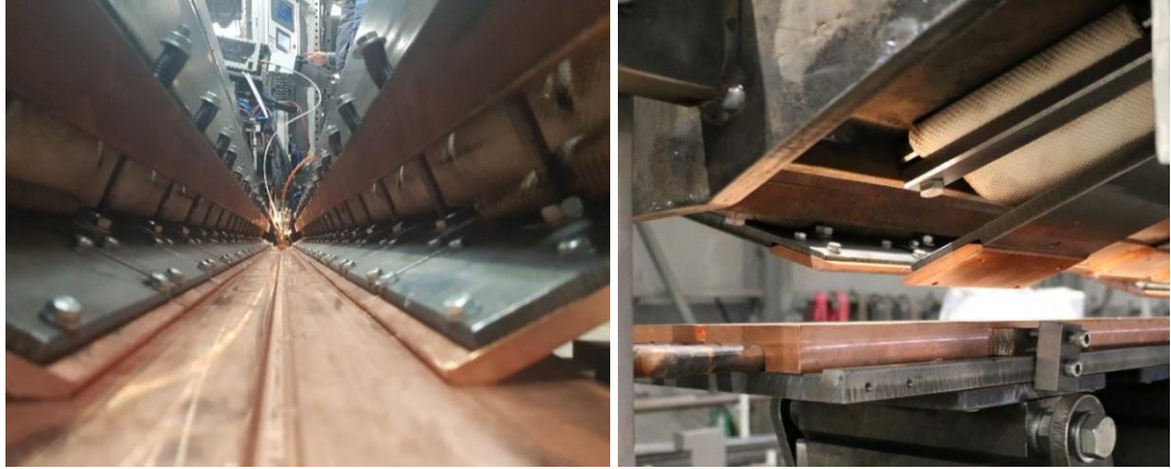
Şekil 3.16. Kaynak makinesine entegre iş parçası bağlama sistemi.
