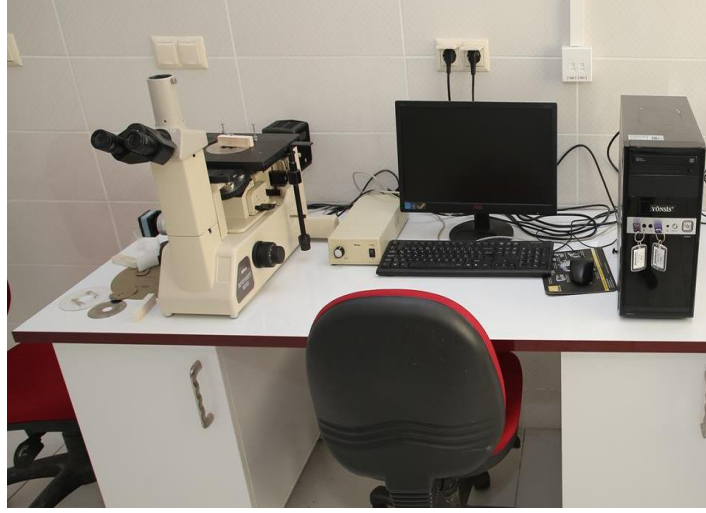
Şekil 3.10. Metalografik incelemelerde kullanılan Nikon Epiphot 200 marka optik mikroskop.
