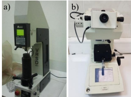
Şekil 3.9. Sertlik ölçüm cihazları; a) üniversal tip makrosertlik ölçüm cihazı, b) mikrosertlik ölçüm cihazı.
