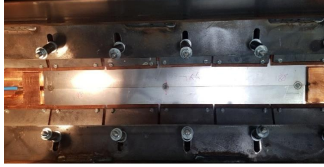
Şekil 3.17. Kaynak işlemi öncesi malzemenin puntalanmış şekli.
