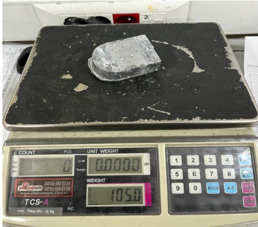
Şekil 9.8. 2. Numune Korozyon Testi Sonrası Ağırlık Ölçümü (gram).
