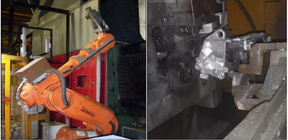
Şekil 6.21. 6 Eksenli para alma robotu ve kalıptan para ıkartma [21].
