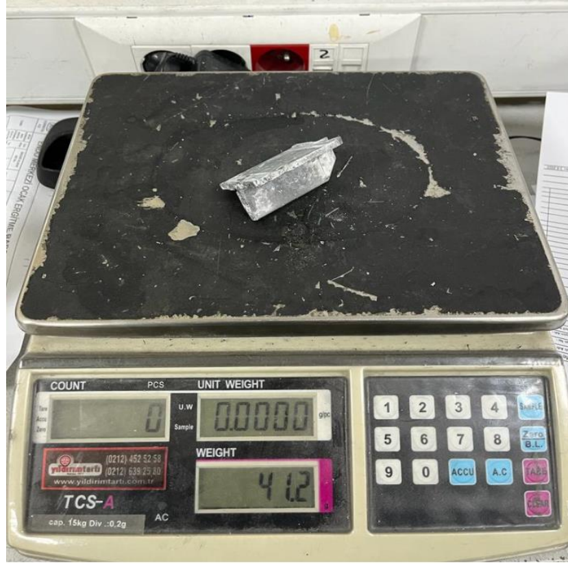
Şekil 9.7. 1. Numune Korozyon Testi Sonrası Ağırlık Ölçümü (gram).
