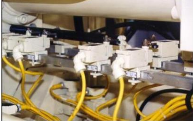
Şekil 6.12. Limit anahtarları / switchlerin gösterimi [21].
