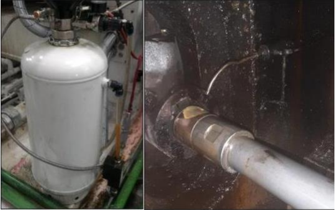
Şekil 6.20. Piston yağlama tankı ve sistemi görselleri [21].
