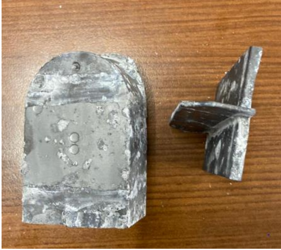
Şekil 9.10. Tuzlu çözelti püskürtme korozyon testi sonucu numune yüzey görünümü.
