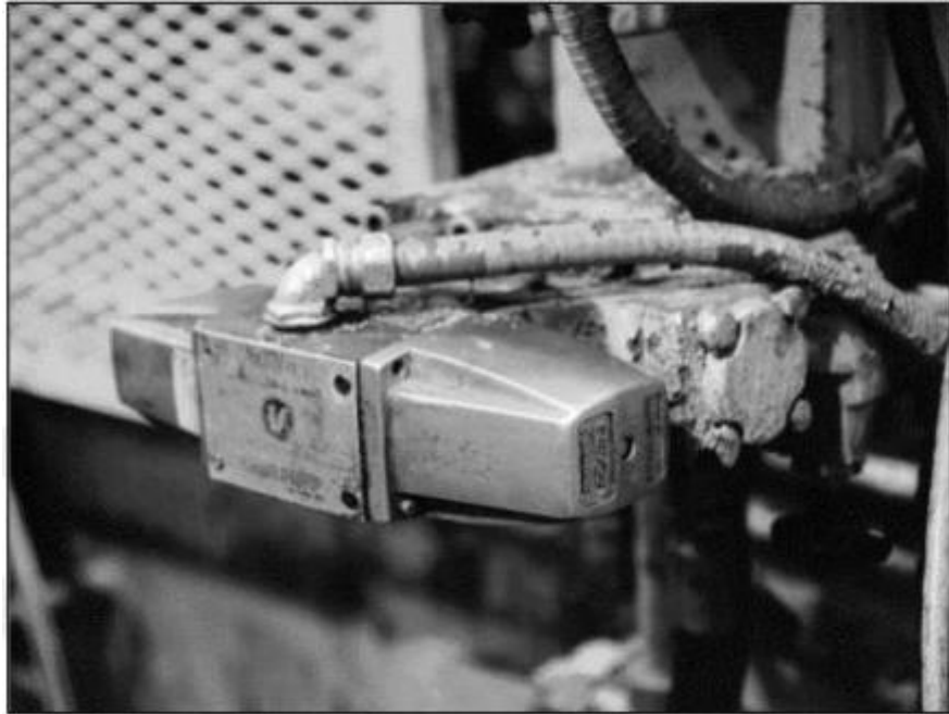
Şekil 6.11. Yüksek basınçlı döküm tezgâhında kullanılan selenoid valf [21].
