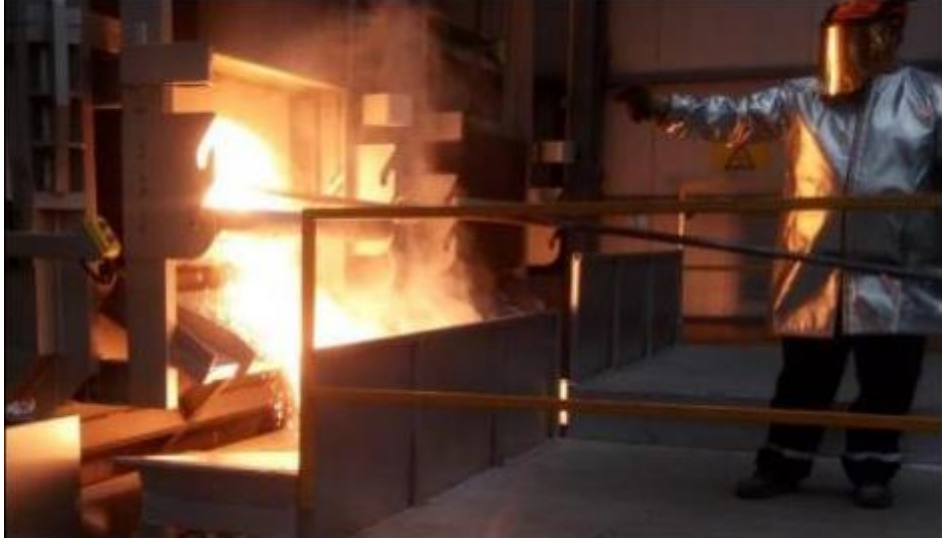
Şekil 6.15. Cüruf alma işlemi [23].
