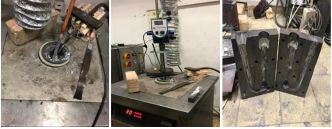
Şekil 3.2. Ergitme Ocağı ve dökülen kalıp.
