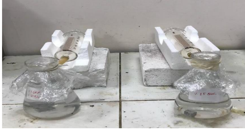
Şekil 3.10. Hidrojen Çıkışı Deney düzeneği görüntüsü.
