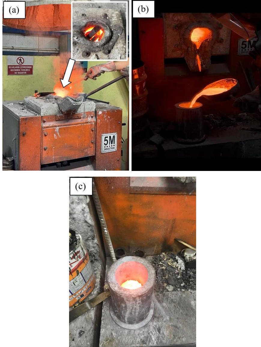
Şekil 7.4. (a) Alaşım üretimi için kullanılan indüksiyon ocağı, (b) Dökümün ara potaya alınması (c) St52 kokil kalıba dökümün gerçekleşmesi.
