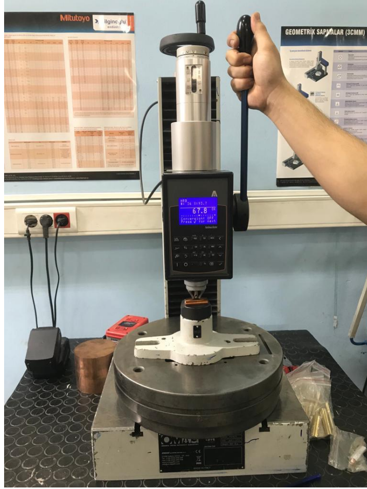
Şekil 7.16. Rockwell B sertlik ölçüm cihazı.
