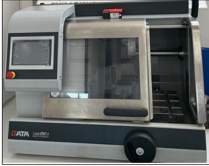
Şekil 7.11. Su soğutmalı hassas kesim cihazı.
