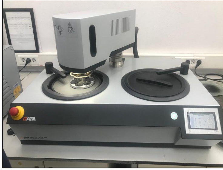
Şekil 7.13. Otomatik zımparalama ve parlatma cihazı.
