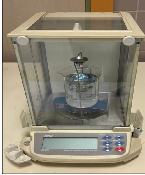
Şekil 7. 23. Hassas terazi ve yoğunluk ölçüm kiti.
