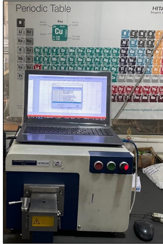
Şekil 7.5. HITACHI optik emisyon spektrometresi.
