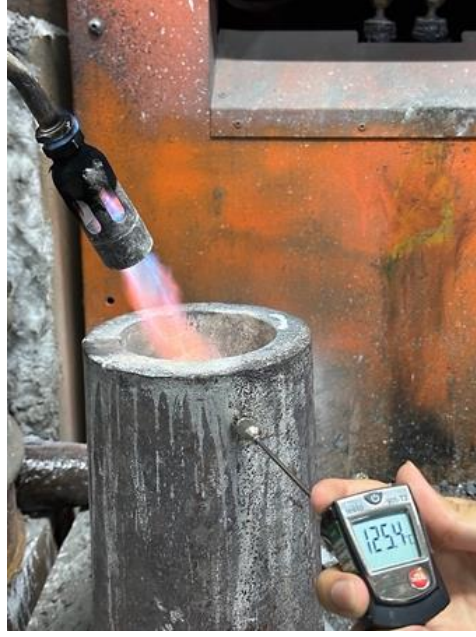
Şekil 7.2. Kokil kalıbın pürmüz yardımı ile ön ısıtma yapılması.
