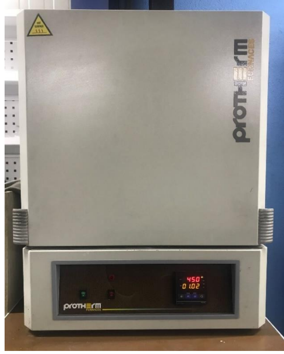
Şekil 7.10. Isıl işlem proseslerinin gerçekleştiği fırın.
