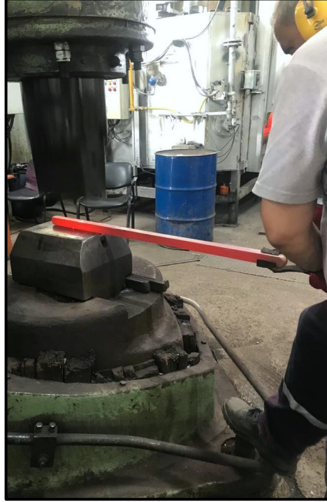
Şekil 7.7. CuNi 2 Si ve CuNiSiCo alaşımlarının endüstriyel ortamda gerçekleşen şahmerdan ile sıcak dövme prosesi.
