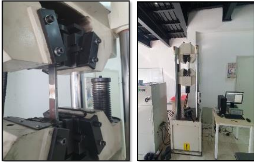
Şekil 6.13. Çekme testi esnası ve cihaz görseli
