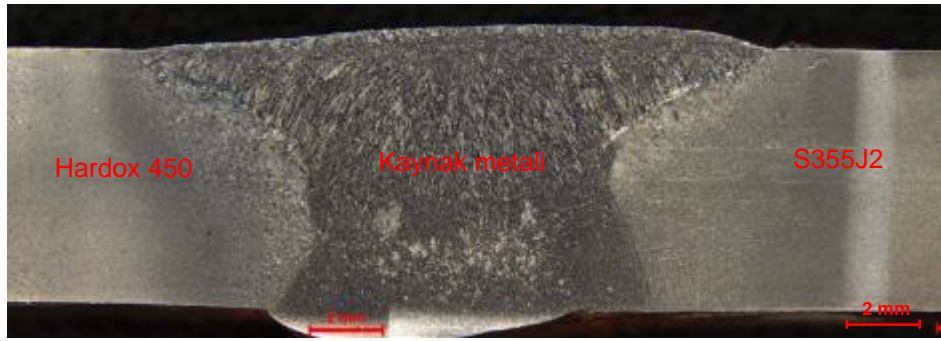
Şekil 7.4. SG3 ile birleştirilen numunenin makro görüntüsü.
