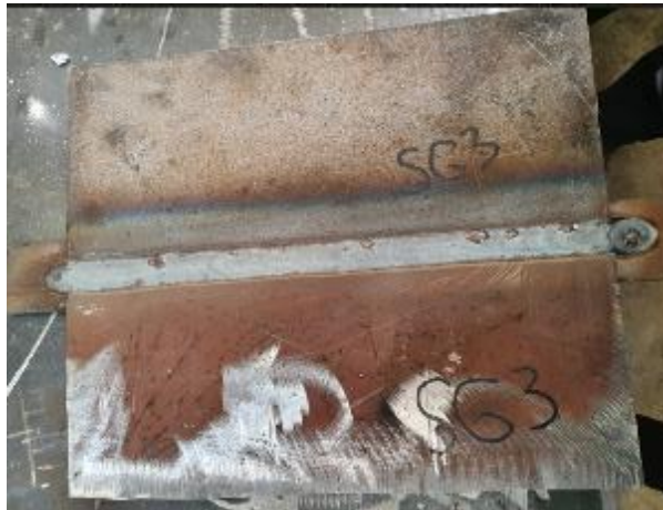
Şekil 6.6. Kaynak sonrası gözle kontrol (SG3 için).
