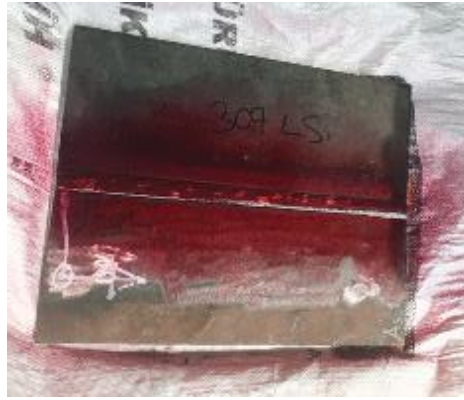
Şekil 6.7. Sıvı penetrant muayenesi.
