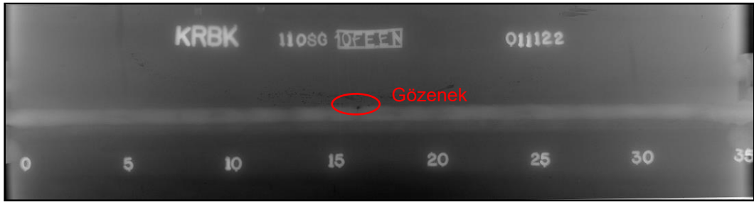
Şekil 7.2. 110SG test numunesi radyografi görüntüsü.
