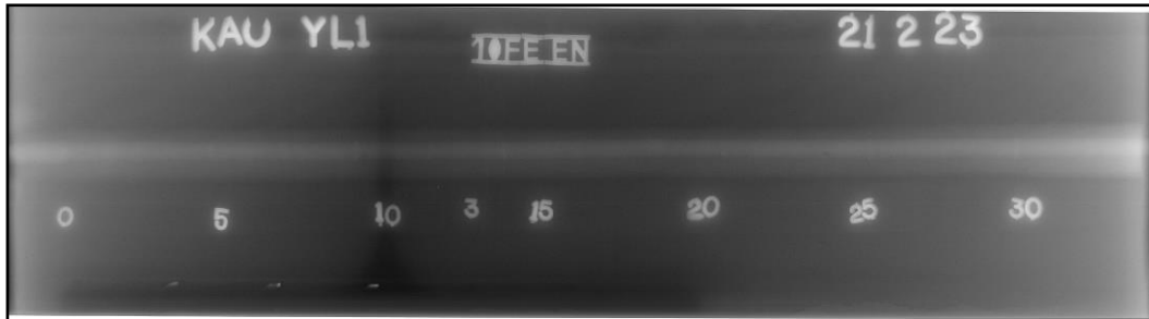
Şekil 7.3. 307LSi test numunesi radyografi görüntüsü.
