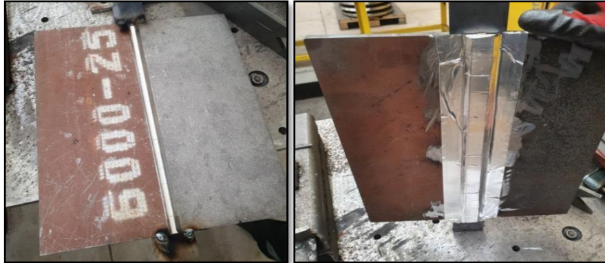
Şekil 6.4. Seramik altlıklı test numunesi.
