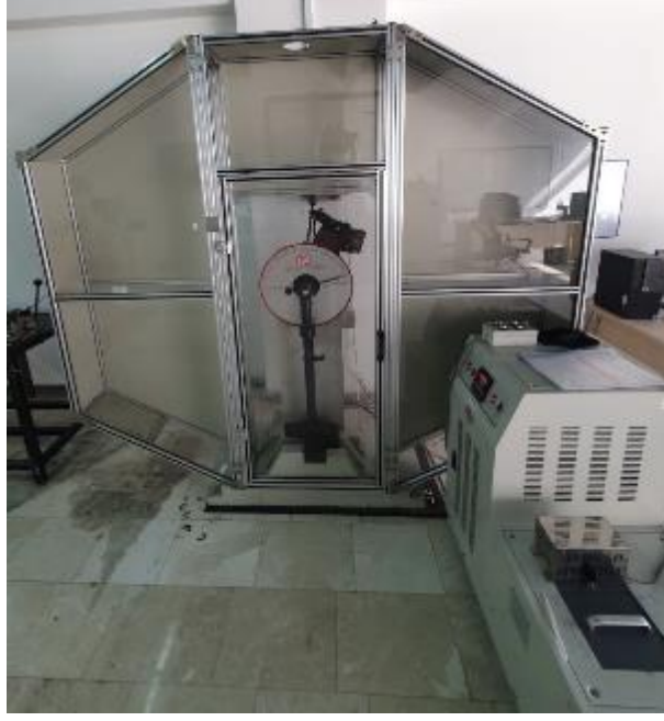
Şekil 6.15. Deneysel çalışmalarda kullanılan çentik darbe test cihazı.
