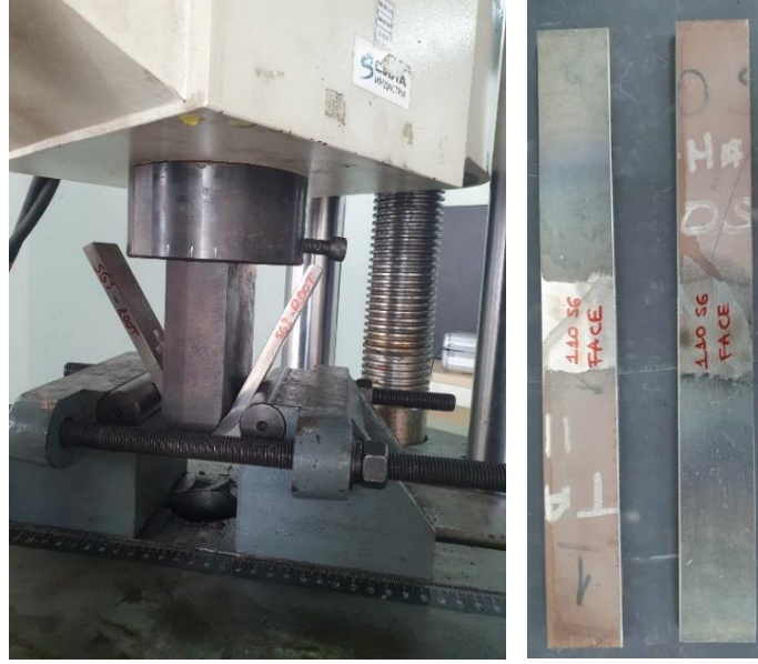
Şekil 6.14. Eğme testi esnası ve eğme numunesi.
