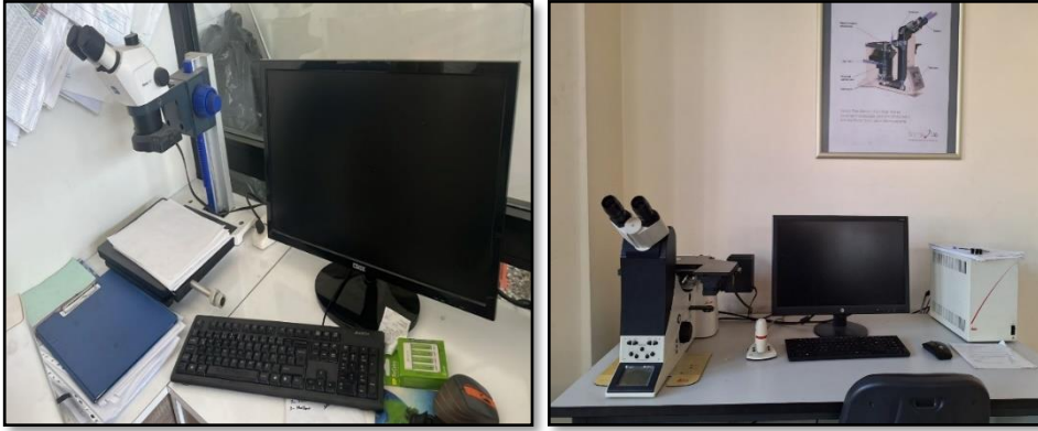
Şekil 6.10. Makro ve mikroyapı incelemede kullanılan cihazlar.
