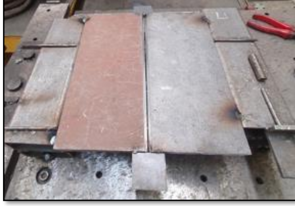
Şekil 6.2. Kaynak öncesi test numune görüntüleri.
