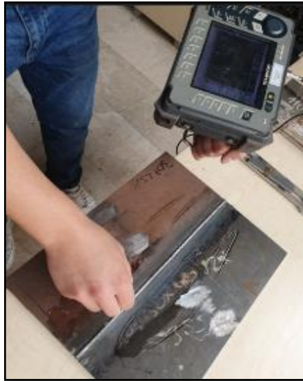
Şekil 6.8. Ultrasonik muayene görseli.
