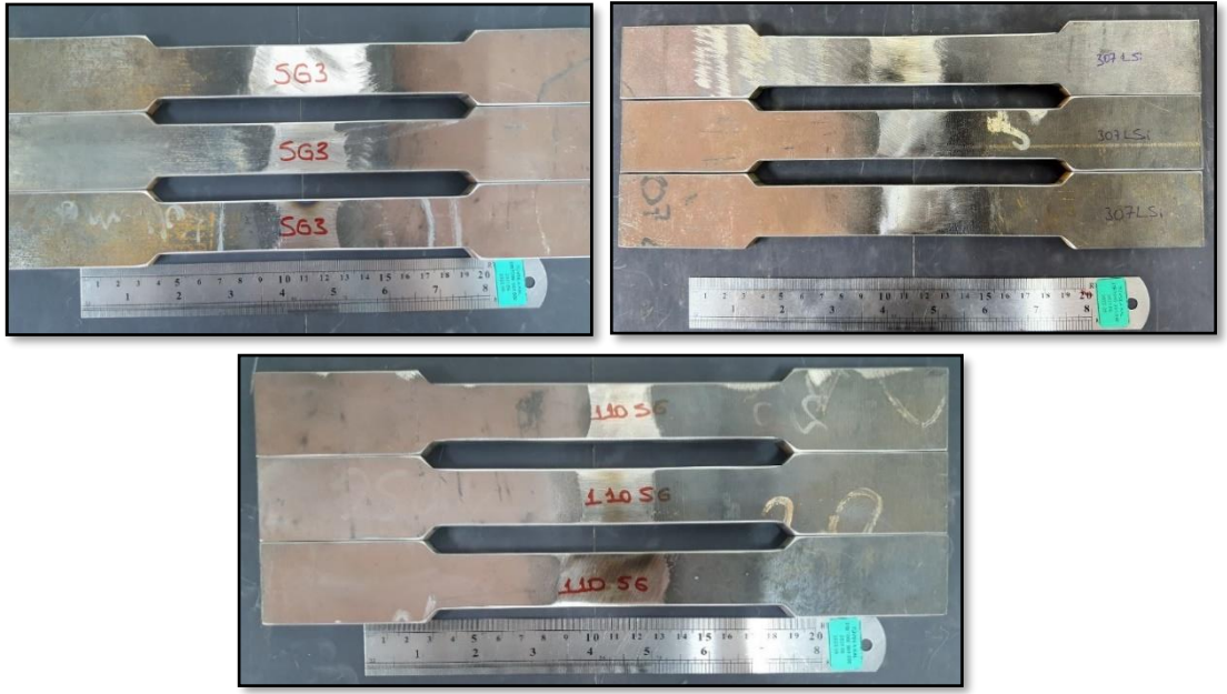
Şekil 6.12. Kaynaklı numunelerden hazırlanan çekme test numuneleri.
