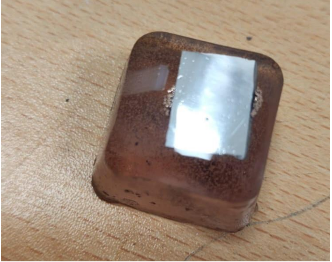
Şekil 3.2 Zımparalama işlemi bitmiş olan numune
