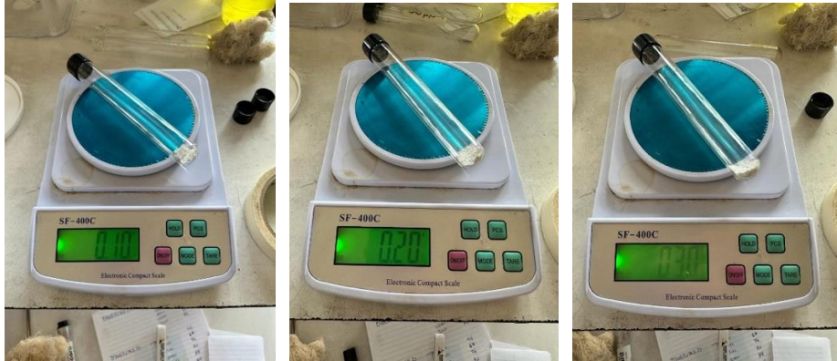
Şekil 6.9. Hassas terazi ile nanoparçacık ölçümü.
