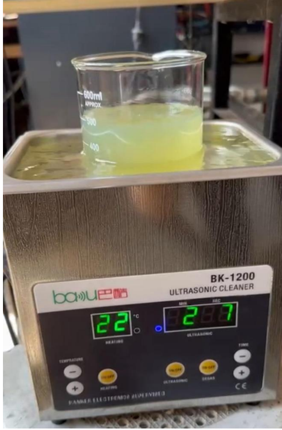
Şekil 6.8. Ultrasonik karıştırıcı ile nanoparçacık içerikli yakıtın karıştırılması.
