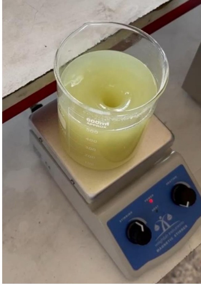
Şekil 6.7. Manyetik karıştırıcıda homojen karışım eldesi.
