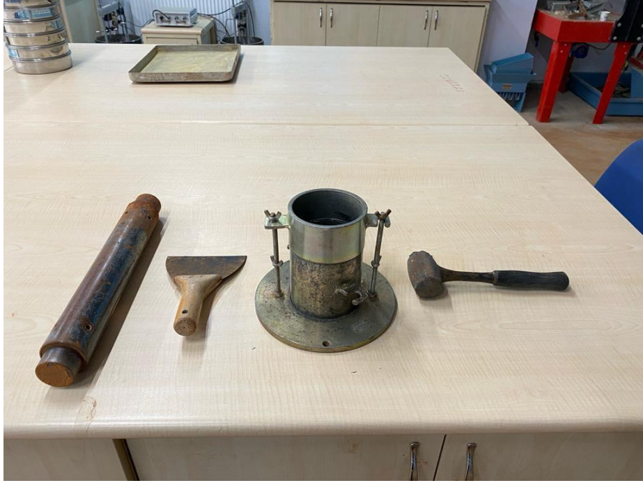
Şekil 2.8 Standart Proctor Deney Seti.
