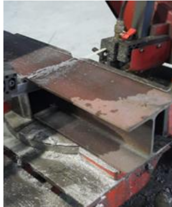
Şekil 3.1. H profilin 25 cm uzunluğunda kesilmesi işlemi.
