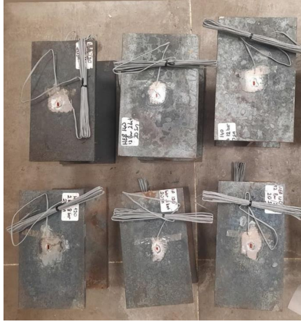
Şekil 3.4. Yapıştırılan gerinim ölçerin üstüne epoksi yapıştırıcı uygulanması.
