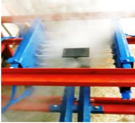
Şekil 2.2. Hızlandırılmış soğutma ısıl işleme uygulaması (HS-KT).
