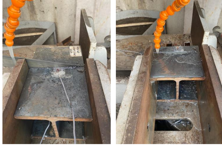
Şekil 3.5. Profilde kesit alma yöntemi ile kalıntı gerilim ölçümü.
