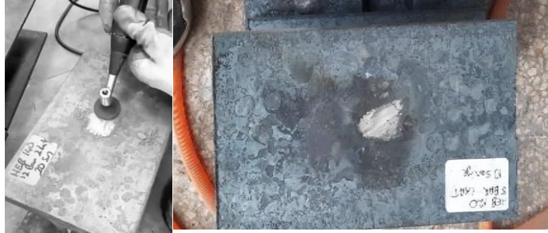
Şekil 3.3. Profil üstünde belirlenen orta noktanın zımparalanması.
