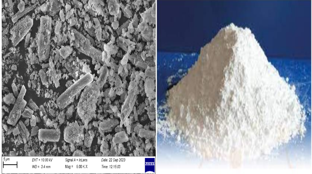
Şekil 6.11. MgO nano parçacıklarının SEM görüntüsü ve fiziksel görünümü [151].
