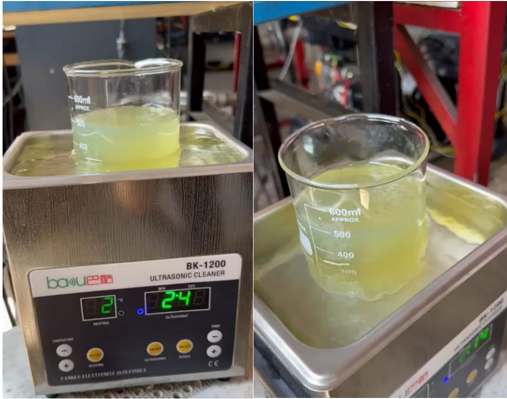
Şekil 6.15. Deney yakıtlarının ultrasonic karıştırıcıda karıştırılması
