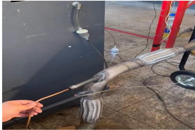
Şekil 6.6. Ölçüm probunun egzoz borusuna yerleşiminin gösterilmesi
