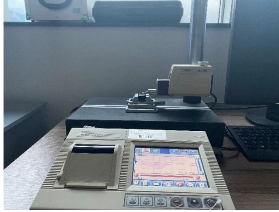
Şekil 4.9 Aşınma Testi Yüzey alanı Ölçüm Cihazı
