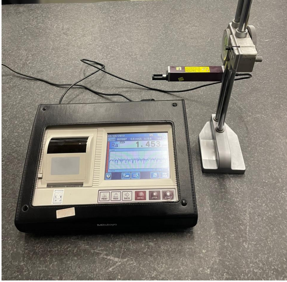
Şekil 4.4. Yüzey pürüzlülüğü değeri ölçüm cihazı ve test düzeneği.
