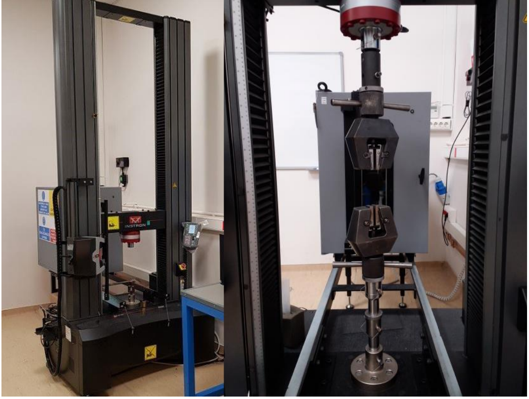
Şekil 4.5. Çekme basma cihazı ve çekme test düzeneği.
