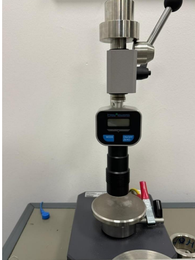
Şekil 4.3. Sertlik ölçüm cihazı ve test düzeneği.
