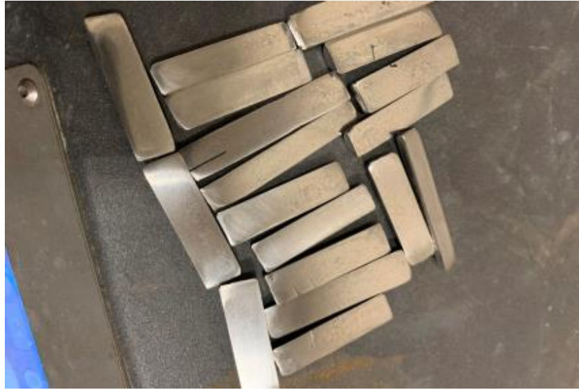
Şekil 6.5. Su jeti ile kesilmiş bi-metal numuneler
