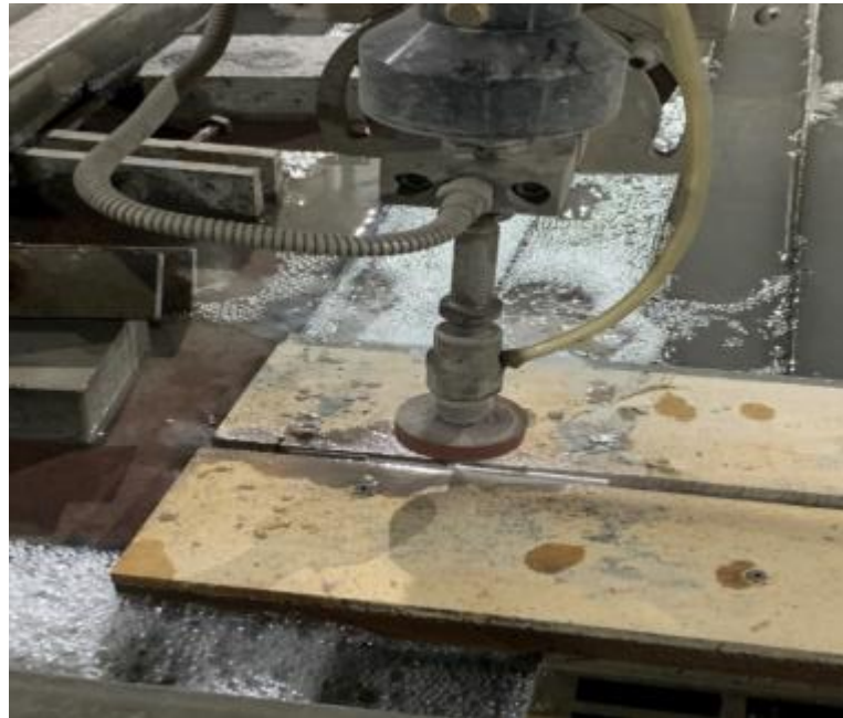
Şekil 6.3. Su jeti makinesi ile kesim işleminin yapılışı
