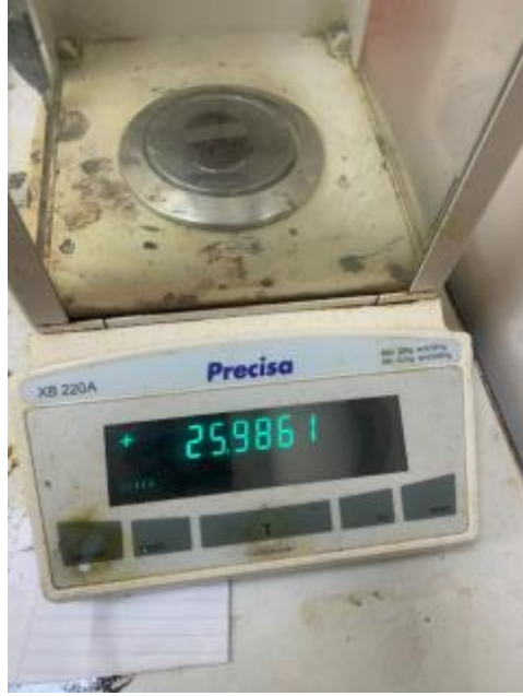
Şekil 6.8. Deneylerde kullanılan PRECISE XB 220A markalı hassas terazi.
