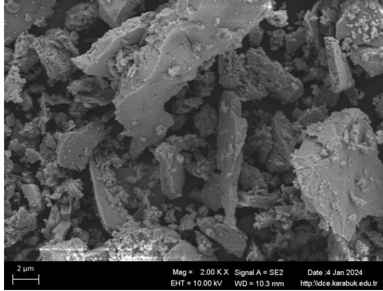
Şekil 5.16. Fe 2 O 3 nano partikülünün 5kx büyütmedeki SEM görüntüsü.
