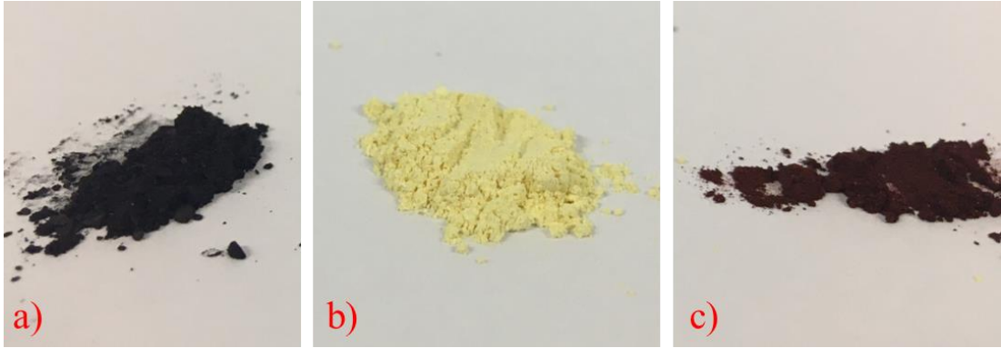
Şekil 4.16. Üretilen nano partiküller. a) MXene nano partikülü, b) g\text{-C}_3\text{N}_4 nano partikülü, c) \text{Fe}_2\text{O}_3 nano partikülü.
