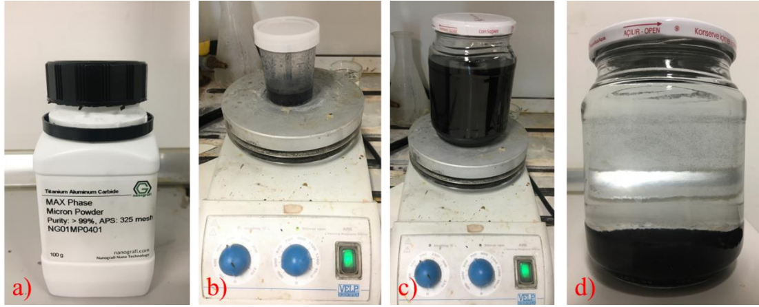
Şekil 4.14. MXene üretim aşamaları. a) MAX fazının elde edilmesi, b) HF sıvısı ile MAX fazının manyetik karıştırıcıda karıştırılması, c) elde edilen çözeltinin pH derecesinin düşürülmesi için saf su ile karıştırılması, d) pH derecesi düşürülen nano partiküllerin çökelme işlemi için beklenilmesi.
