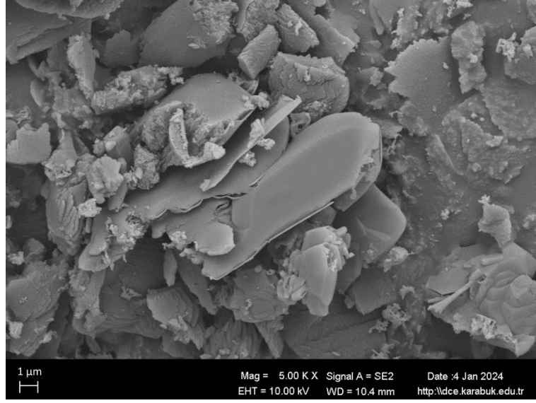
Şekil 5.18. g-C 3 N 4 nano partikülünün 5kx SEM görüntüsü.
