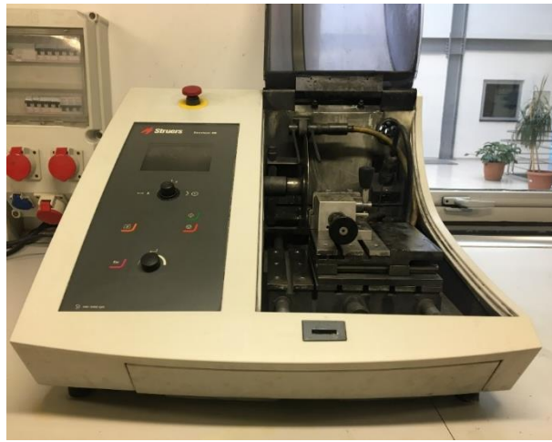
Şekil 4.19. Hassas kesme cihazı.
