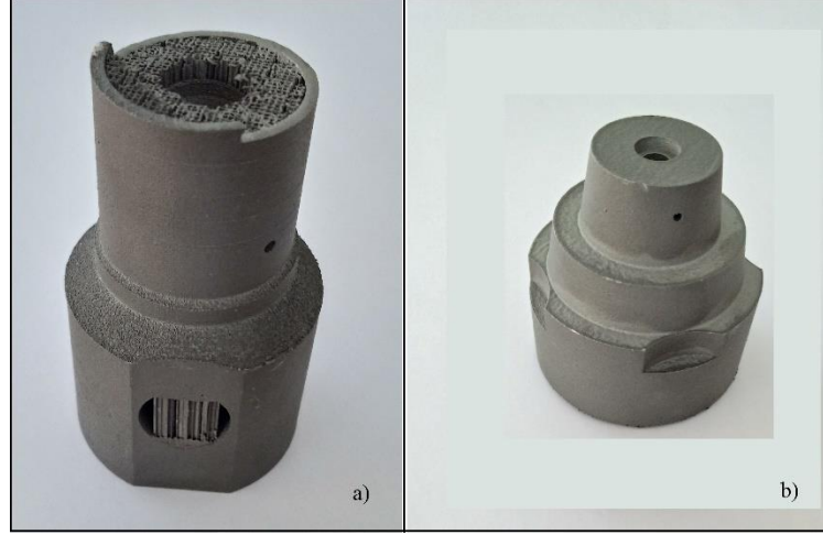
Şekil 3.9. Metal eklemeli imalat yöntemiyle üretilen kaba çekirdekler.
