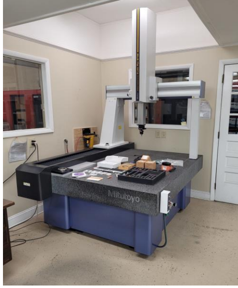
Şekil 3.31. Mitutoyo CMM cihazı.
