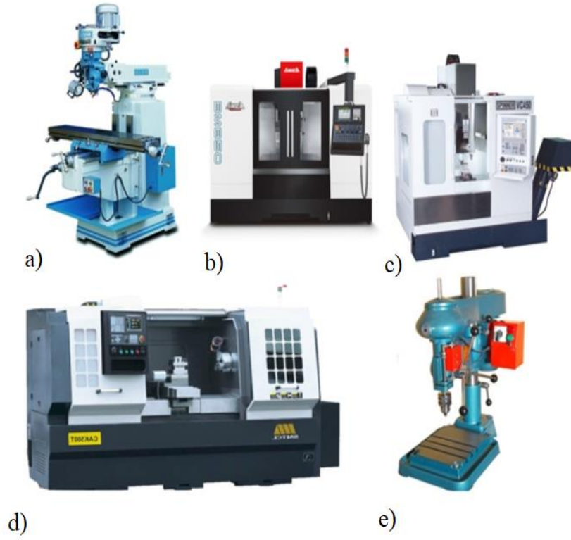
Şekil 2.24. a) Kalıpcı frezesi b) CNC Freze c) CNC freze d) CNC torna e) Sabit matkap.
