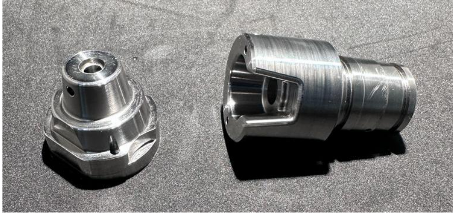
Şekil 3.10. Metal eklemeli imalat ile üretilen finiş çekirdekler.
