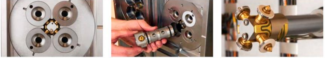
Şekil 3.3. Sıcak yolluk ve çekirdeklerin yerleşimi.
