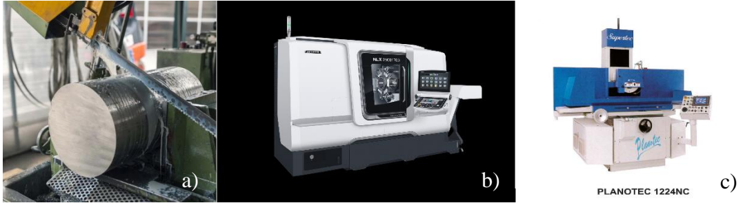
Şekil 3.7. a) Yuvarlak çelik testeresi b) DMG Mori NLX 2500 / 700 CNC torna c) Supertech PL-1224NC taşlama.
