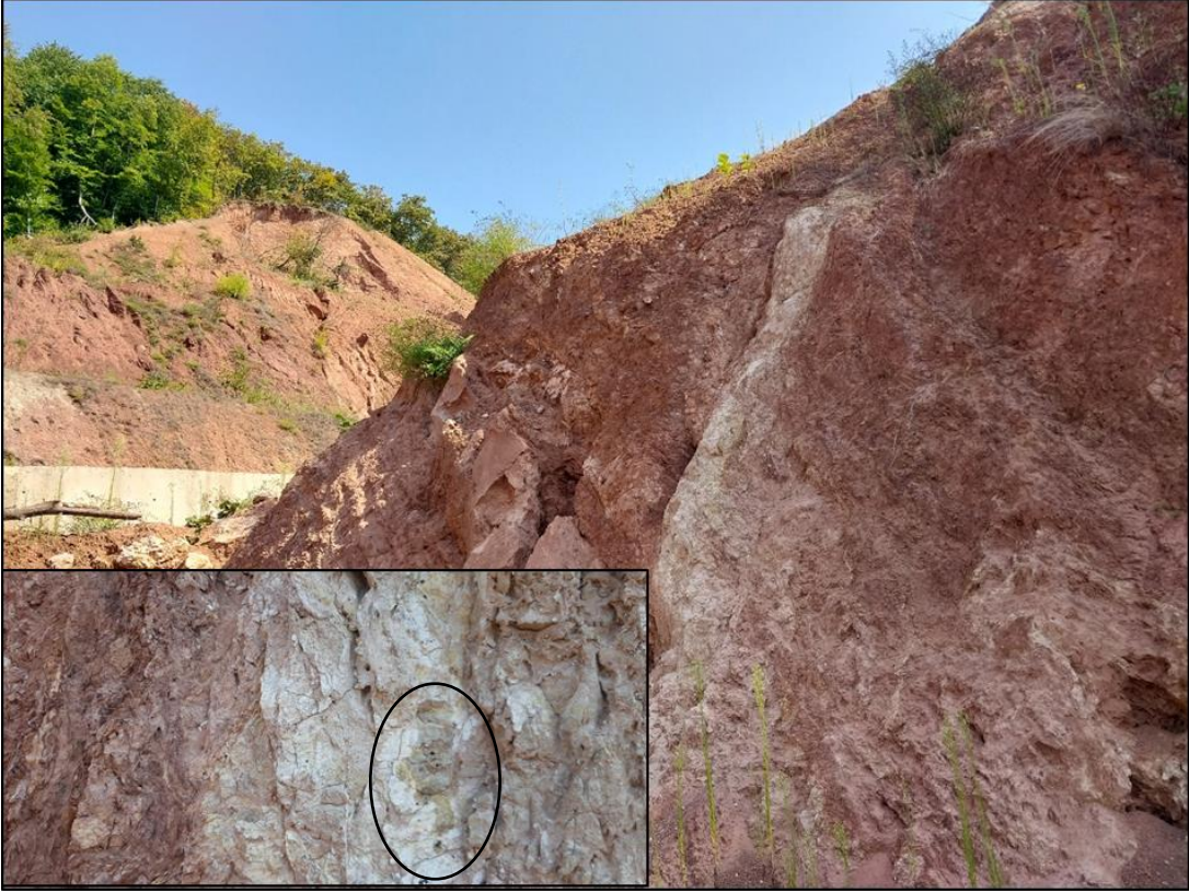
Foto 1: Arıt Çayı Havzası'nda kırmızımsı renkli flişlere hidroklorik asit damlatılmış ve asite tepki vermedikleri belirlenmiştir.
