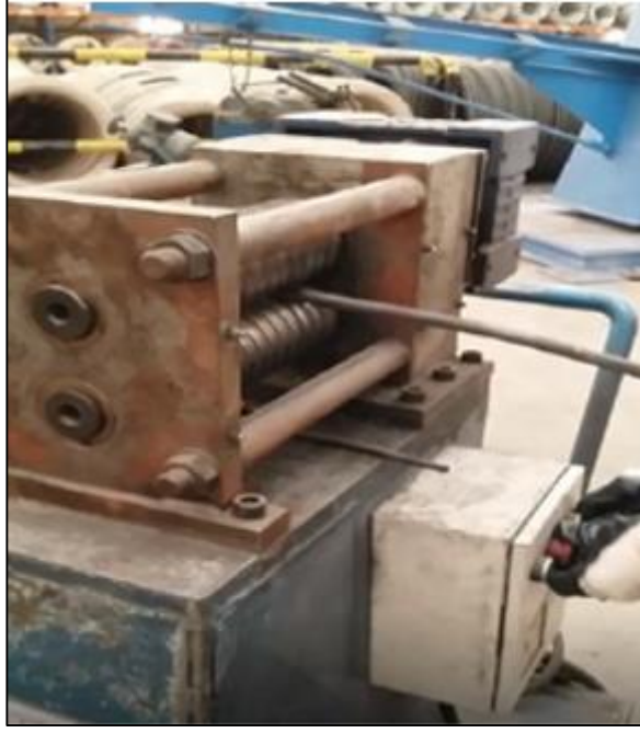
Şekil 3.2. Kuru çekme- uç açma ve haddeden geçirme [14].
