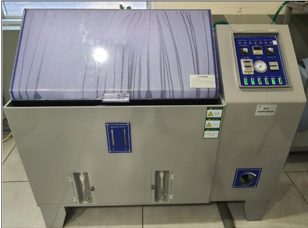
Şekil 5.17. Tuz testi cihazı.
