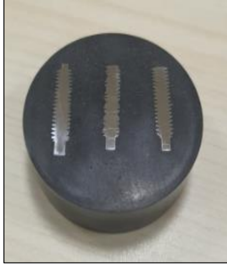
Şekil 5.13. 20MnB4 hammaddesinden üretilen ısıı işlem görmüş numune bakalit görüntüsü.
