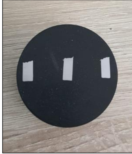
Şekil 5.14. QST32 hammaddesinden üretilen ısıı işlem görmüş numune bakalit görüntüsü.
