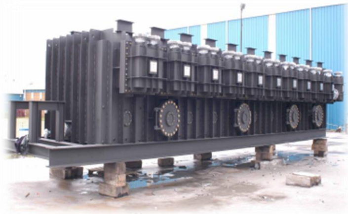
Şekil 3.4. Deniz suyu flaş odası tesisi için tasarlanmış evaporatör kovanları serisi.
