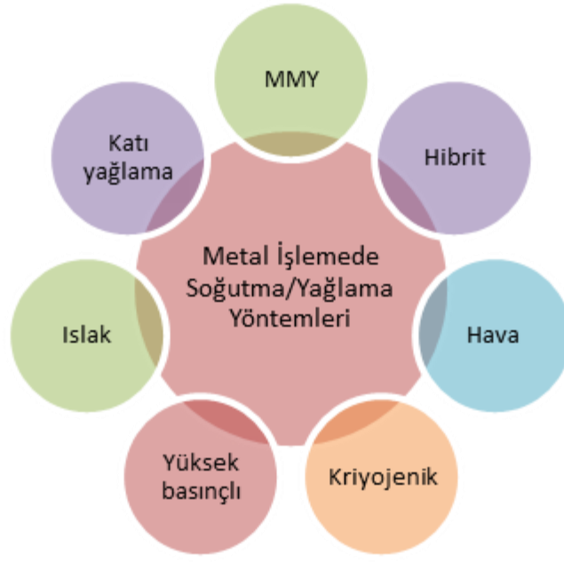
Şekil 5.3. Metal işlemede kullanılan soğutma/yağlama yöntemleri [134].
