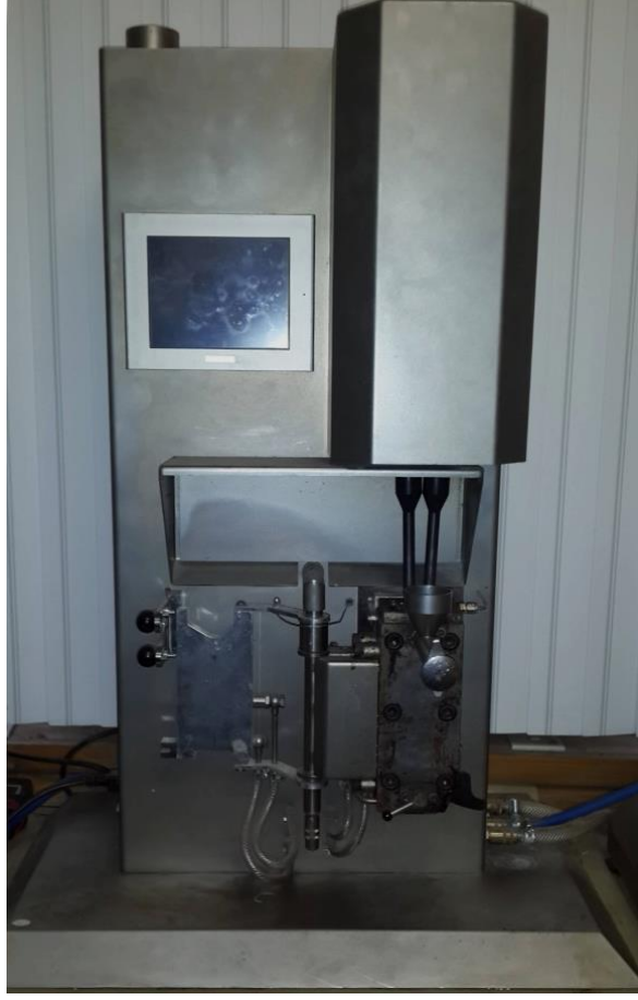
Şekil 3.1. Laboratuvar ölçekli çift vidalı ekstrüder [10].
