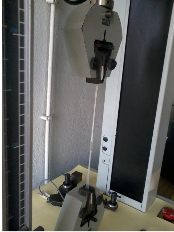
Şekil 3.5. Çekme testi cihazı [10].
