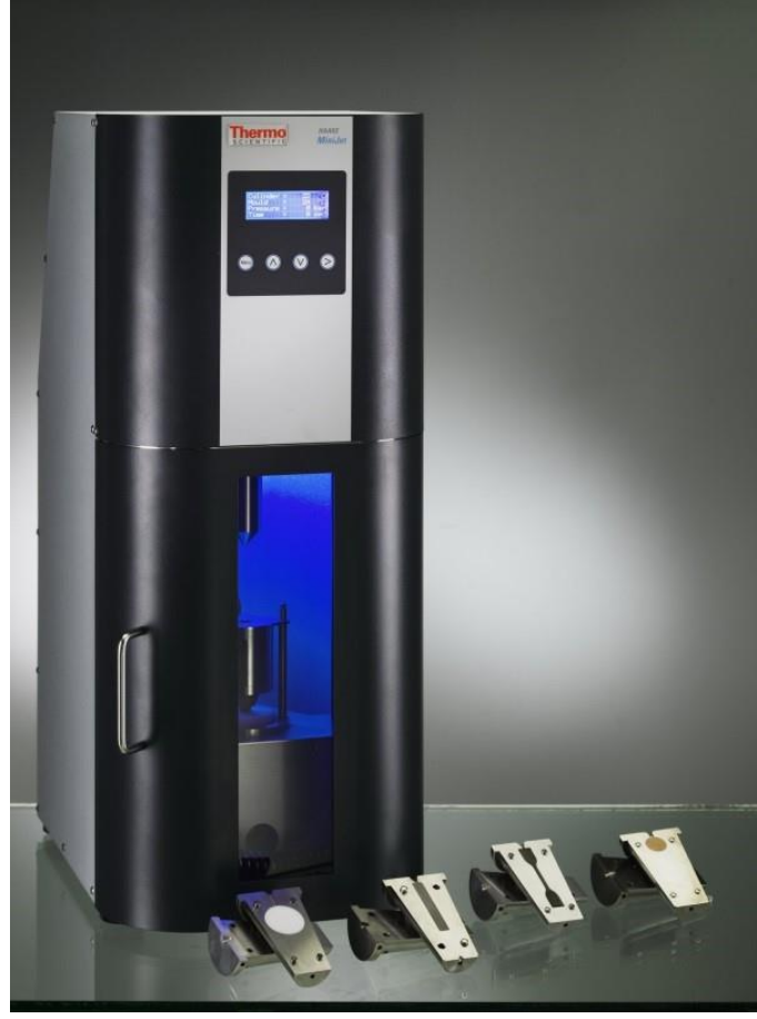
Şekil 3.2. Plastik enjeksiyon kalıplama cihazı [26].
