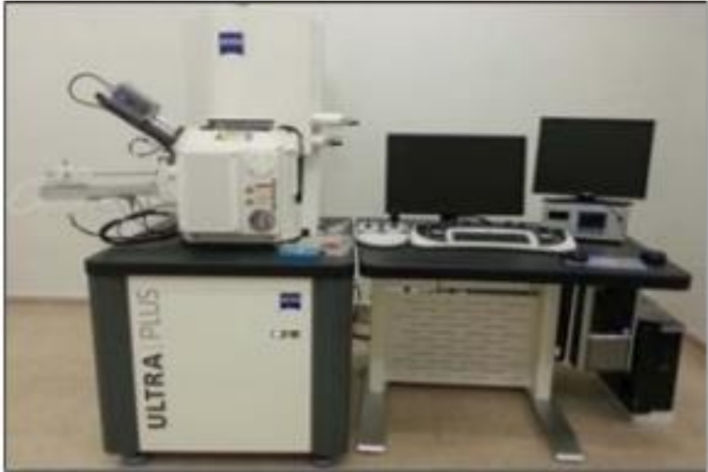
Şekil 3.4. Alan etkili taramalı elektron mikroskobu (FESEM) [27].
