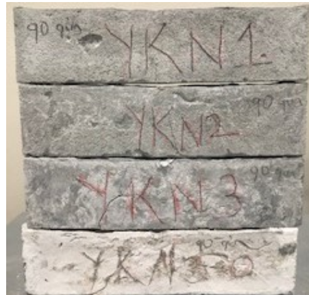
Şekil B.5. YBN1, YBN2, YBN3 ve YBN3-0 90 günlük eğilme deney sonrası numuneler
