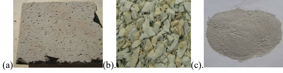
Şekil 3.5. Bayburt yeşil trası, a) Kırılmadan önce, b) Kırıldıktan sonra, c) Öğütülmüş
