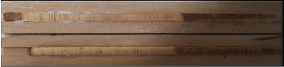
Fotoğraf 11: Zımpara öncesinde artım kalemleri ahşap taşıyıcılara yapıştırılmıştır.
