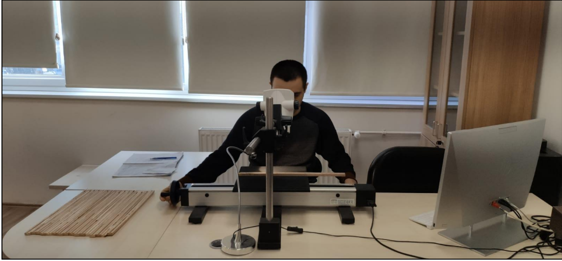
Fotoğraf 13: Yıllık halka genişliklerinin LINTAP-TSAP programında ölçüm aşaması. (Örnekler Karabük Üniversitesi Coğrafya Bölümü Dendrokronoloji Laboratuvarında ölçülmüştür).
