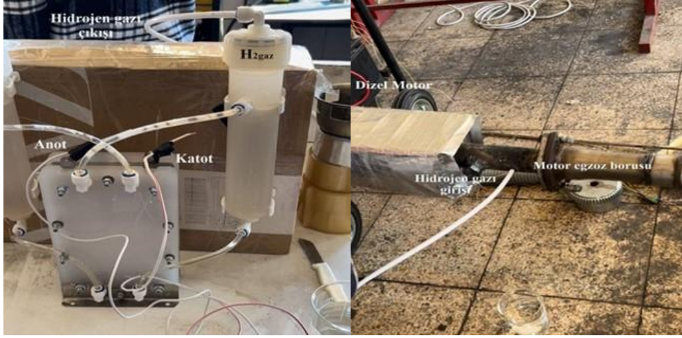
Şekil 6.4. Hidrojen gazı çıkışı ve girişi.
