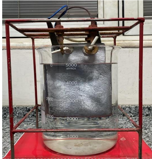
Şekil 4.27. Liç çözeltisi sıvısının elektrolizi.
