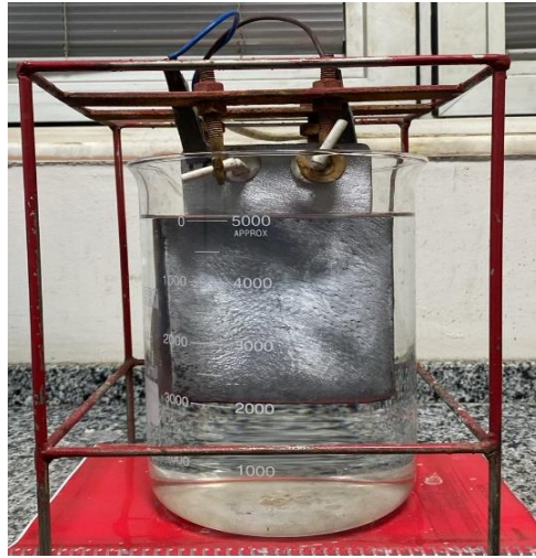
Şekil 4.37. Liç çözeltisi sıvısının elektrolizi.
