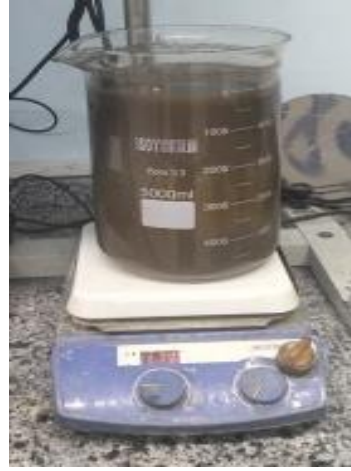
Şekil 4.113. 508,14 gr H 2 SO 4 ilavesi sonrası liç çözeltisi, Ph:4,5.
