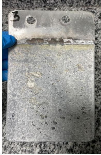
Şekil 4.38. Elektroliz sonrası Al (katot) plaka ön yüz.
