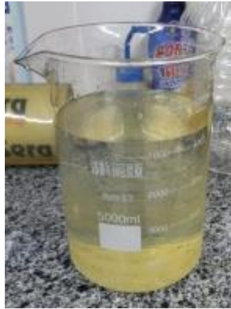
Şekil 4.146. Elektrolize hazır liç çözeltisi sıvısı.
