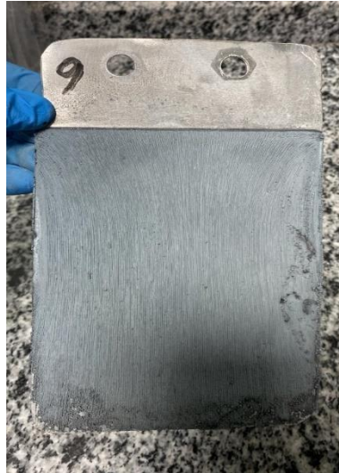
Şekil 4.88. Elektroliz sonrası Al (katot) plaka ön yüz.
