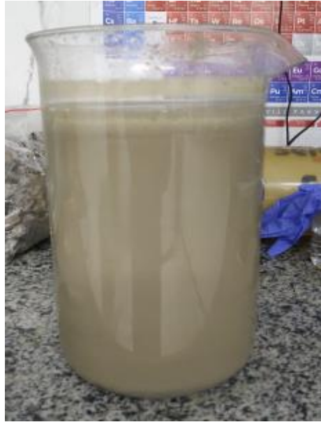
Şekil 4.14. Liç çözeltisi dinlenmeye alınma uygulaması.
