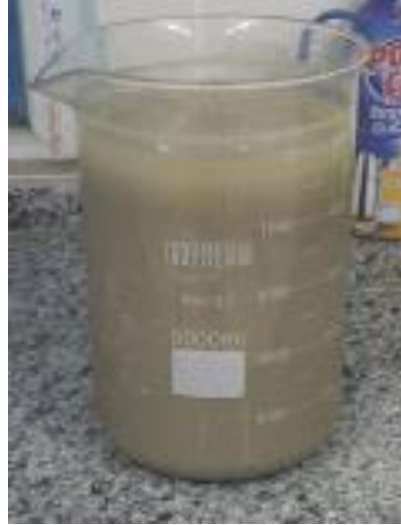
Şekil 4.64. Liç çözeltilisi dinlenmeye alınma uygulaması.
