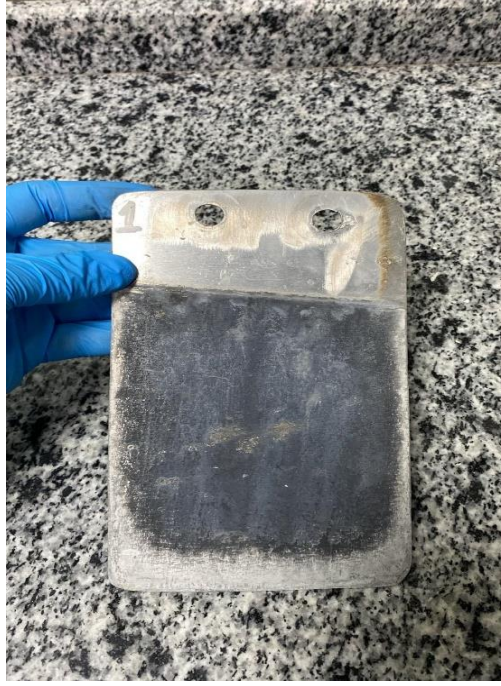
Şekil 4.9. Elektroliz sonrası Al (katot) plaka arka yüz.
