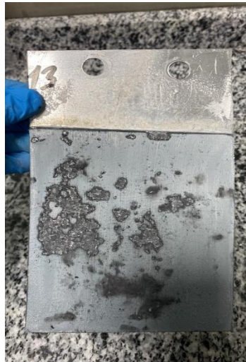
Şekil 4.128. Elektroliz sonrası Al (katot) plaka ön yüzü.
