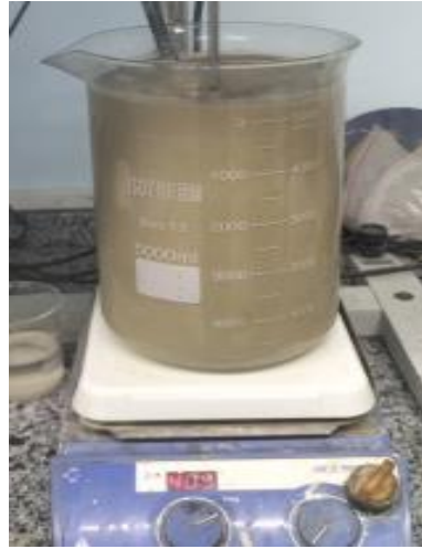
Şekil 4.72. 500 gr ürün ilavesi sonrası liç çözeltisi, pH: 10,36.
