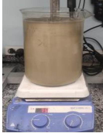
Şekil 4.92. 500 gr ürün ilavesi sonrası liç çözeltisi, pH: 10,36.
