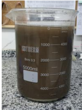
Şekil 4.124. Liç çözeltisi dinlenmeye alınma uygulaması.
