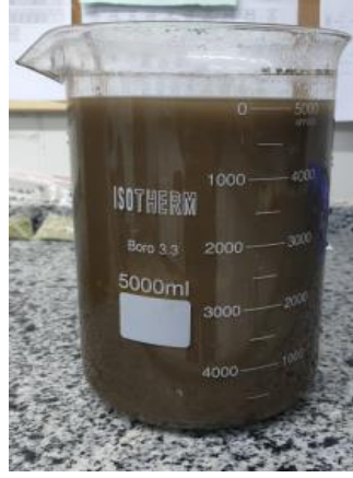
Şekil 4.134. Liç çözeltisi dinlenmeye alınma uygulaması.
