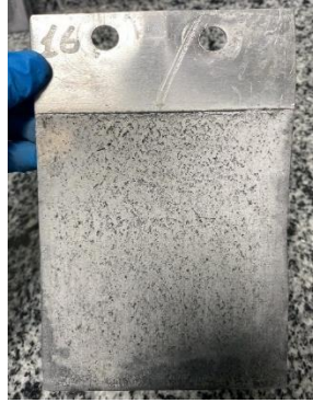
Şekil 4.158. Elektroliz sonrası Al (katot) plaka ön yüz.
