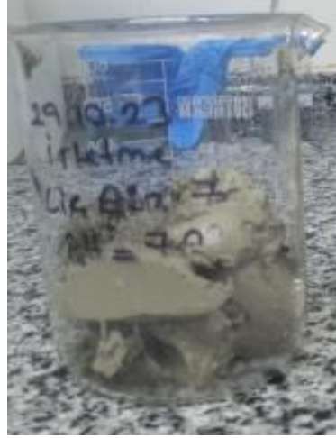
Şekil 4.65. Dinlendirilen liç çözeltisi yağsız vakum pompası yardımı ile süzülen liç atığı.
