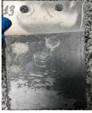
Şekil 4.129. Elektroliz sonrası Al (katot) plaka arka yüz.
