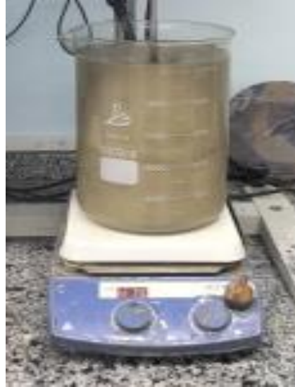
Şekil 4.102. 500 gr ürün ilavesi sonrası liç çözeltisi, pH: 10,36.
