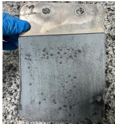
Şekil 4.118. Elektroliz sonrası Al (katot) plaka ön yüz.
