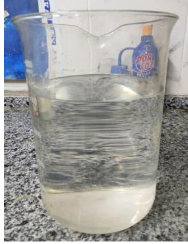
Şekil 4.56. Elektrolize hazır liç çözeltisi sıvısı.
