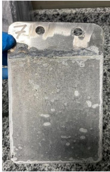
Şekil 4.69. Elektroliz sonrası Al (katot) plaka arka yüz.
