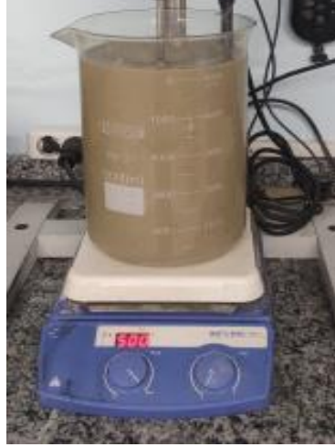
Şekil 4.43. 3,33 gr H 2 SO 4 ilavesi sonrası liç çözeltisi, pH:8,0.
