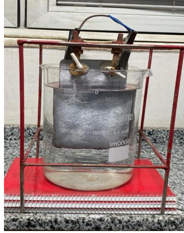
Şekil 4.87. Liç çözeltisi sıvısının elektrolizi.
