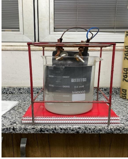
Şekil 4.7. Liç çözeltisi sıvısının elektrolizi.
