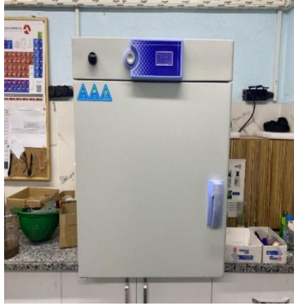
Şekil 3.5. EFLAB marka laboratuvar tipi kurutma fırını (Etüv).
