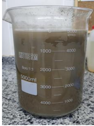
Şekil 4.84. Liç çözeltisi dinlenmeye alınma uygulaması.
