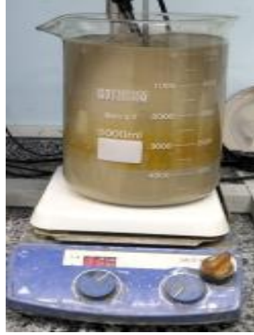
Şekil 4.112. 500 gr ürün ilavesi sonrası liç çözeltisi, pH: 10,36.
