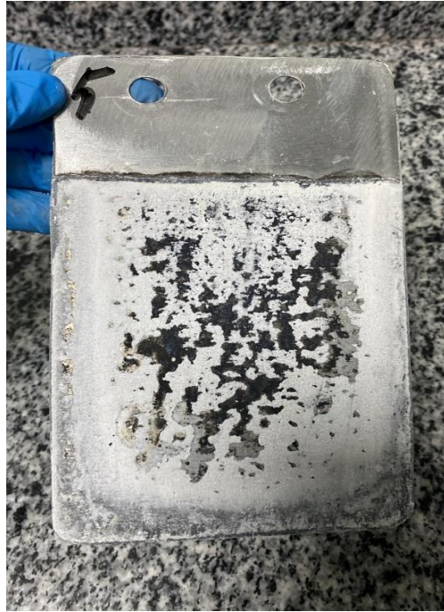
Şekil 4.48. Elektroliz sonrası Al (katot) plaka ön yüz.
