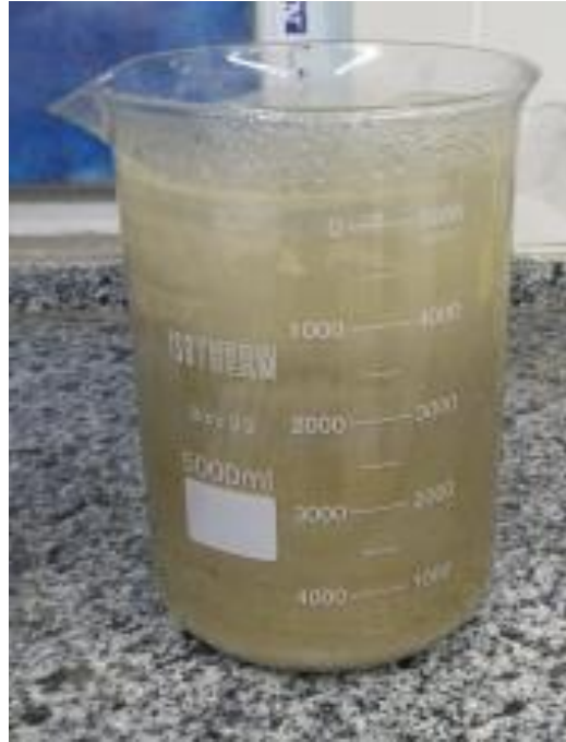
Şekil 4.34. Liç çözeltisi dinlenmeye alınma uygulaması
