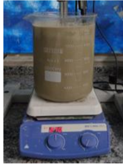
Şekil 4.3. 0,95 gr H 2 SO 4 ilavesi sonrası liç çözeltisi, pH:10
