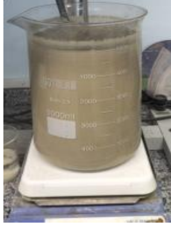
Şekil 4.73. 12,01 gr H_2SO_4 ilavesi sonrası liç çözeltisi, pH:6,5.
