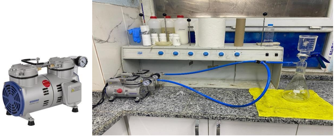
Şekil 3.4. Wiggins marka laboratuvar tipi yağsız vakum pompası.
