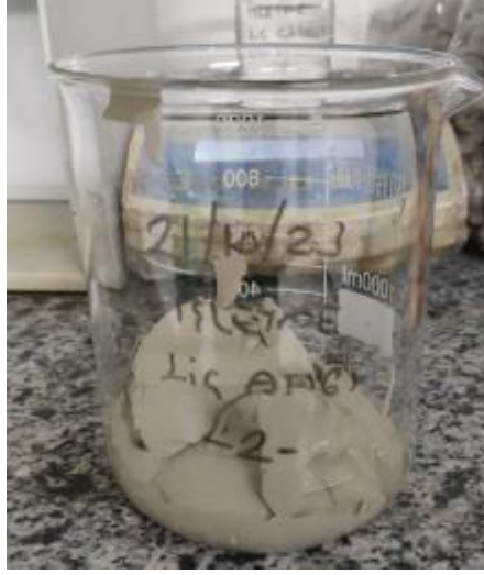
Şekil 4.15. Dinlendirilen liç çözeltisi yağsız vakum pompası yardımı ile süzülen liç atığı.
