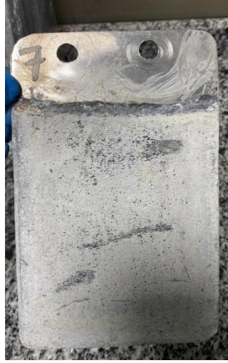
Şekil 4.68. Elektroliz sonrası Al (katot) plaka ön yüz.
