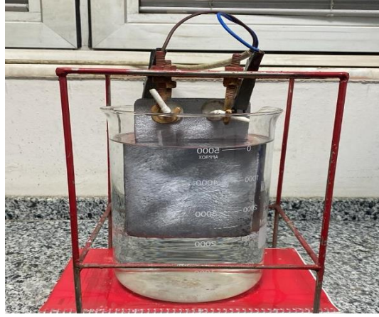
Şekil 4.47. Liç çözeltisi sıvısının elektrolizi
