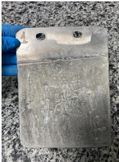
Şekil 4.8. Elektroliz sonrası Al (katot) plaka ön yüz.
