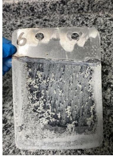
Şekil 4.58. Elektroliz sonrası Al (katot) plaka ön yüz.
