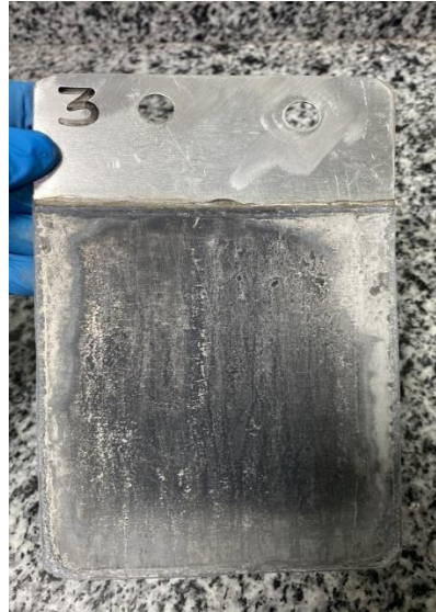
Şekil 4.39. Elektroliz sonrası Al (katot) plaka arka yüz.
