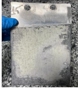
Şekil 4.149. Elektroliz sonrası Al (katot) plaka arka yüz.
