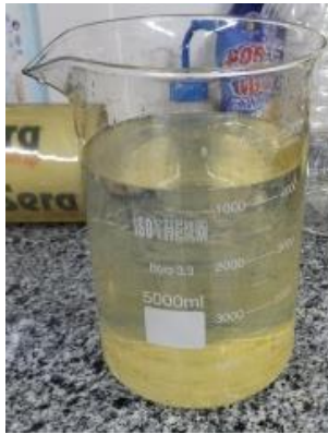
Şekil 4.116. Elektrolize hazır liç çözeltisi sıvısı.
