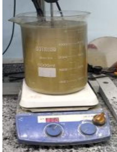
Şekil 4.182. 500 gr ürün ilavesi sonrası liç çözeltisi, pH: 10,36.
