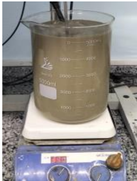
Şekil 4.22. 500 gr ürün ilavesi sonrası liç çözeltisi, pH: 10,36.
