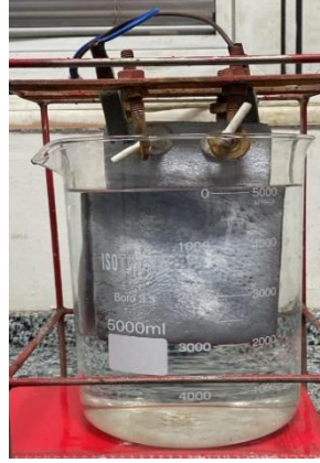
Şekil 4.117. Liç çözeltilisi sıvısının elektrolizi.
