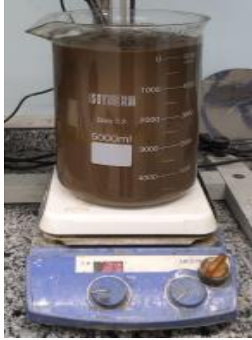
Şekil 4.133. 518,65 gr H_2SO_4 ilavesi sonrası liç çözeltisi, pH:3,5.
