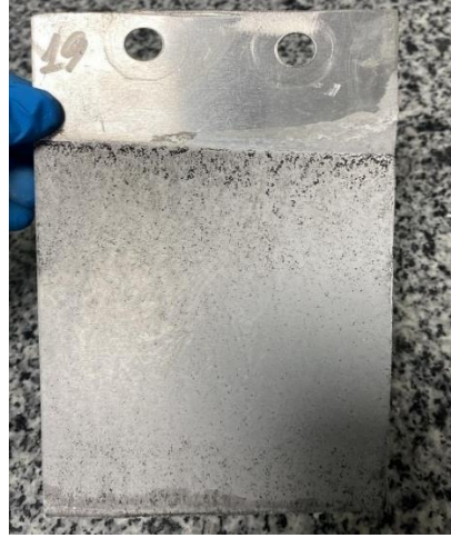
Şekil 4.189. Elektroliz sonrası Al (katot) plaka arka yüz.
