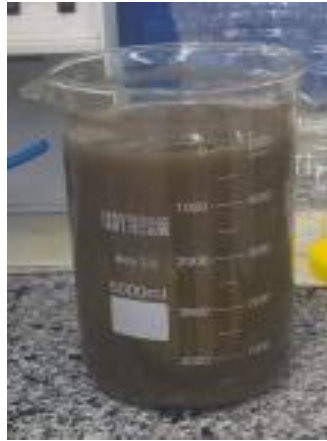
Şekil 4.114. Liç çözeltisi dinlenmeye alınma uygulaması.
