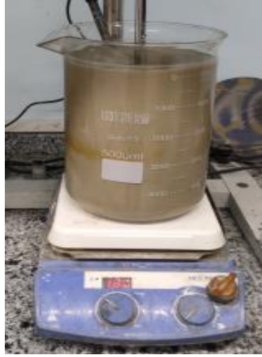
Şekil 4.132. 500 gr ürün ilavesi sonrası liç çözeltisi, pH: 10,36.
