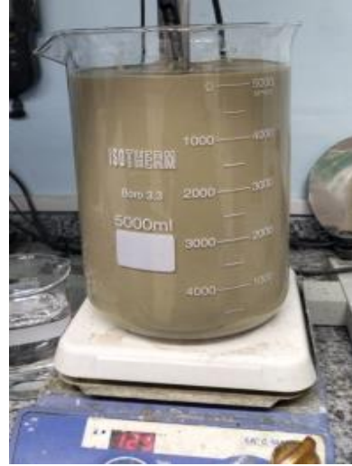
Şekil 4.172. 500 gr ürün ilavesi sonrası liç çözeltisi, pH: 10,36.
