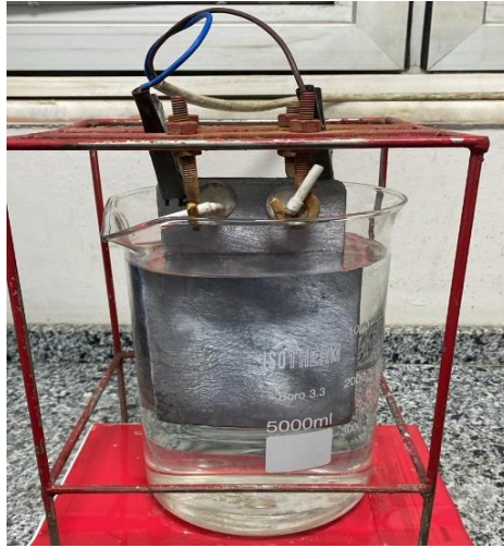
Şekil 4.67. Liç çözeltisi sıvısının elektrolizi.
