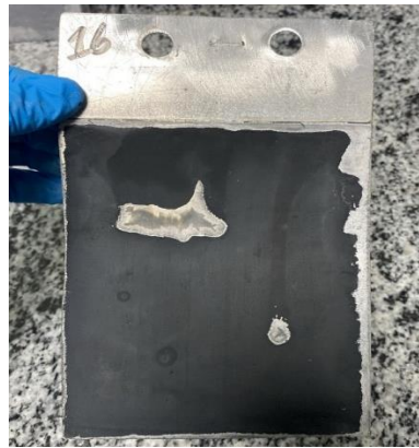
Şekil 4.159. Elektroliz sonrası Al (katot) plaka arka yüz.
