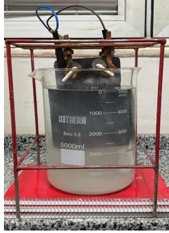
Şekil 4.187. Liç çözeltisi sıvısının elektrolizi.
