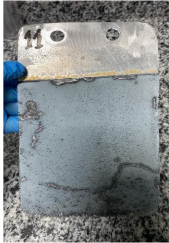
Şekil 4.108. Elektroliz sonrası Al (katot) plaka ön yüz.
