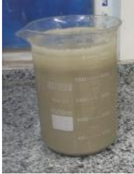
Şekil 4.74. Liç çözeltisi dinlenmeye alınma uygulaması
