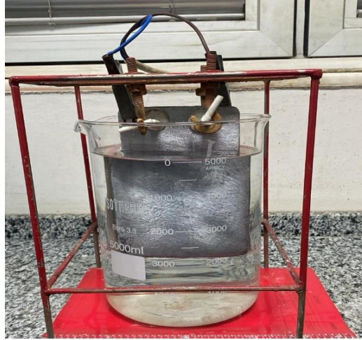
Şekil 4.57. Liç çözeltisi sıvısının elektrolizi.
