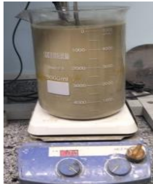
Şekil 4.152. 500 gr ürün ilavesi sonrası liç çözeltisi, pH: 10,36.
