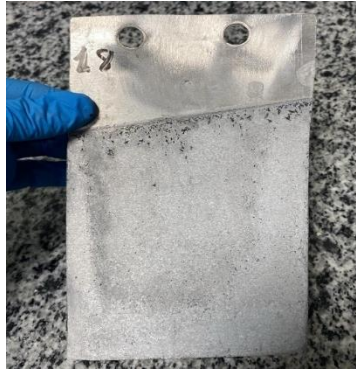
Şekil 4.178. Elektroliz sonrası Al (katot) plaka ön yüz.
