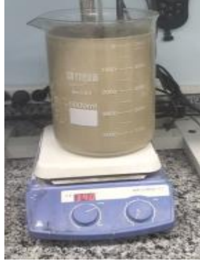
Şekil 4.63. 1,50 gr H 2 SO 4 ilavesi sonrası liç çözeltilisi, pH:7,0.
