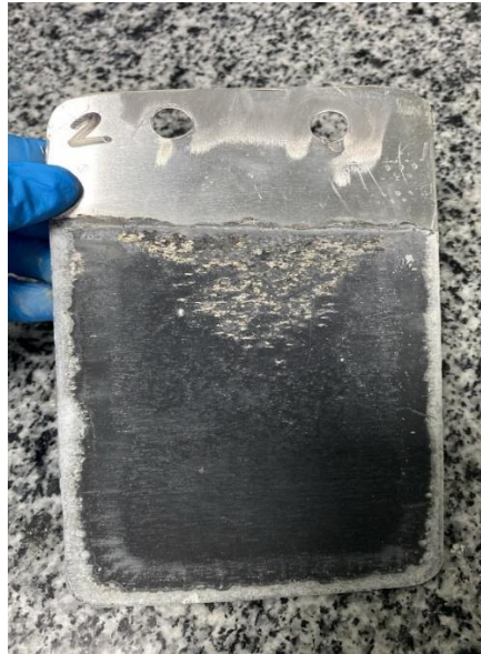
Şekil 4.19. Elektroliz sonrası Al (katot) plaka arka yüz.
