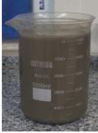
Şekil 4.183. 954,15 gr H 2 SO 4 ilavesi sonrası liç çözeltisi, pH:1,0.
