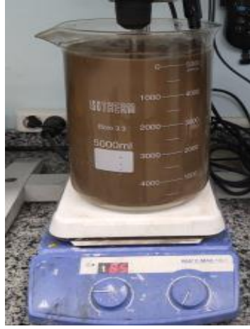
Şekil 4.123. 495,43 gr H_2SO_4 ilavesi sonrası liç çözeltisi, pH:4,0.
