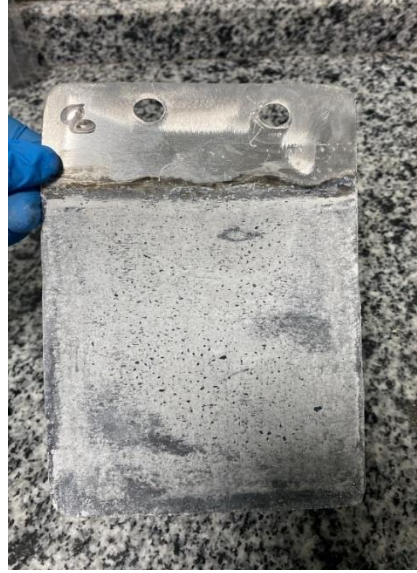
Şekil 4.78. Elektroliz sonrası Al (katot) plaka ön yüz.
