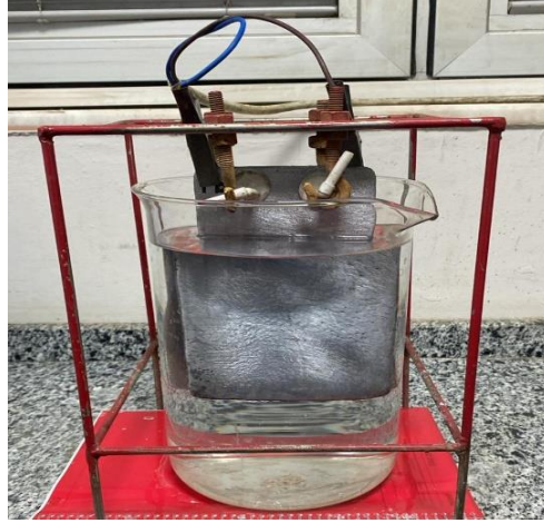
Şekil 4.77. Liç çözeltisi sıvısının elektrolizi.
