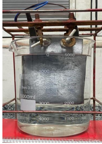
Şekil 4.147. Liç çözeltisi sıvısının elektrolizi.
