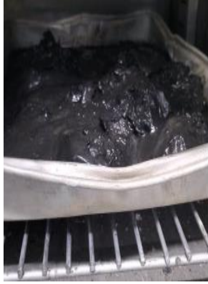
Şekil 4.25. Dinlendirilen liç çözeltisi yağsız vakum pompası yardımı ile süzülen liç atığı.
