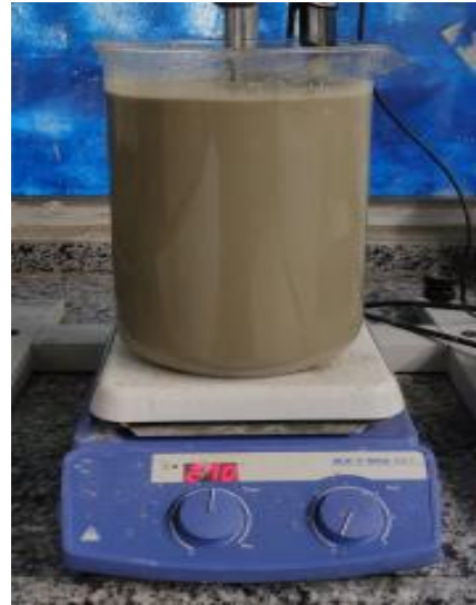
Şekil 4.12. 500 gr ürün ilavesi sonrası liç çözeltisi, pH: 10,36.
