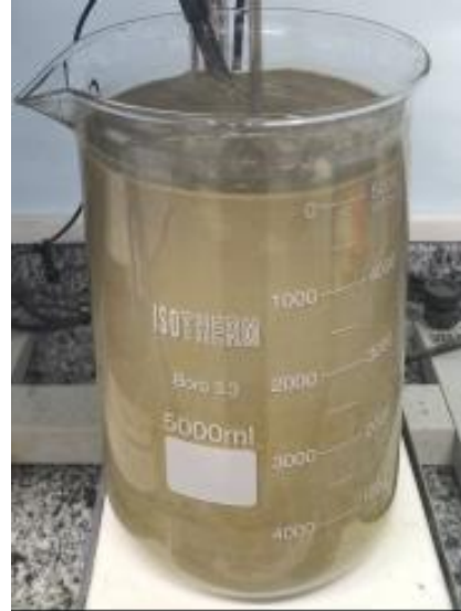
Şekil 4.32. 500 gr ürün ilavesi sonrası liç çözeltisi, pH: 10,36.
