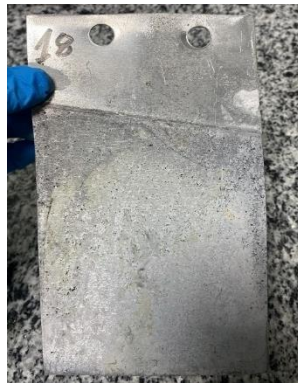
Şekil 4.179. Elektroliz sonrası Al (katot) plaka arka yüz.
