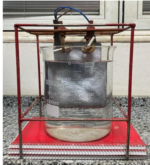
Şekil 4.17. Liç çözeltili sıvısının elektrolizi.
