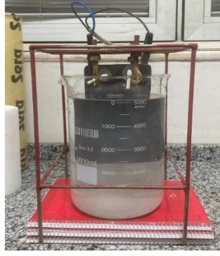
Şekil 4.177. Liç çözeltisi sıvısının elektrolizi.
