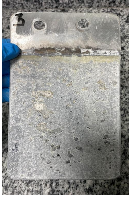
Şekil 4.28. Elektroliz sonrası Al (katot) plaka ön yüz.
