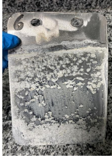
Şekil 4.59. Elektroliz sonrası Al (katot) plaka arka yüz.
