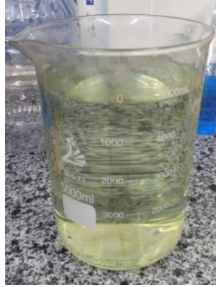
Şekil 4.186. Elektrolize hazır liç çözeltisi sıvısı.
