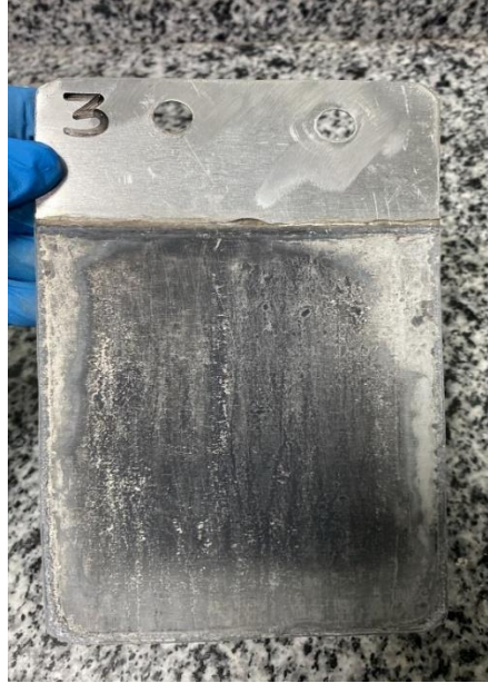
Şekil 4.29. Elektroliz sonrası Al (katot) plaka arka yüz.
