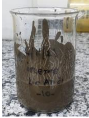
Şekil 4.95. Dinlendirilen liç çözeltisi yağsız vakum pompası yardımı ile süzülen liç atığı.
