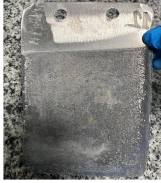
Şekil 4.119. Elektroliz sonrası Al (katot) plaka arka yüz.
