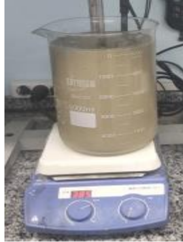
Şekil 4.62. 500 gr ürün ilavesi sonrası liç çözeltisi, pH: 10,36.
