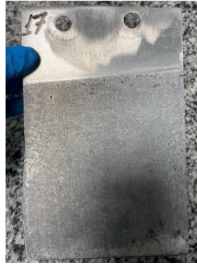
Şekil 4.168. Elektroliz sonrası Al (katot) plaka ön yüz.
