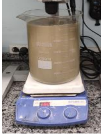
Şekil 4.122. 500 gr ürün ilavesi sonrası liç çözeltisi, pH: 10,36.
