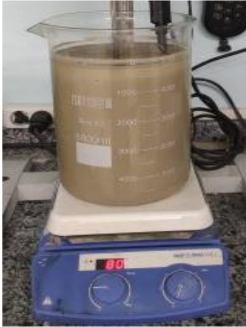
Şekil 4.53. 5,20 gr H 2 SO 4 ilavesi sonrası liç çözeltisi, pH:7,5.
