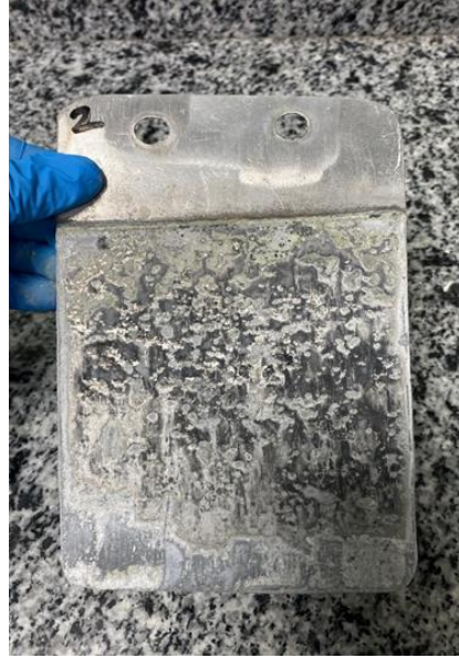
Şekil 4.18. Elektroliz sonrası Al (katot) plaka ön yüz.
