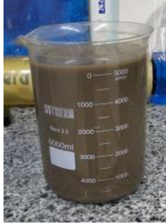
Şekil 4.174. Liç çözeltisi dinlenmeye alınma uygulaması.
