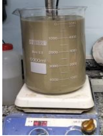
Şekil 4.162. 500 gr ürün ilavesi sonrası liç çözeltisi, pH: 10,36.
