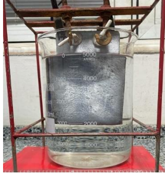
Şekil 4.157. Liç çözeltisi sıvısının elektrolizi.
