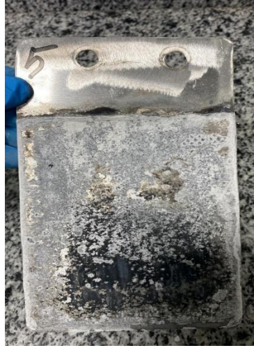
Şekil 4.49. Elektroliz sonrası Al (katot) plaka arka yüz.
