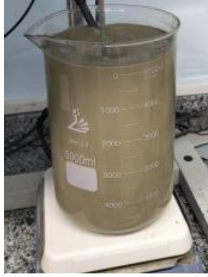
Şekil 4.23. 1,78 gr H_2SO_4 ilavesi sonrası liç çözeltisi, pH:9,0.
