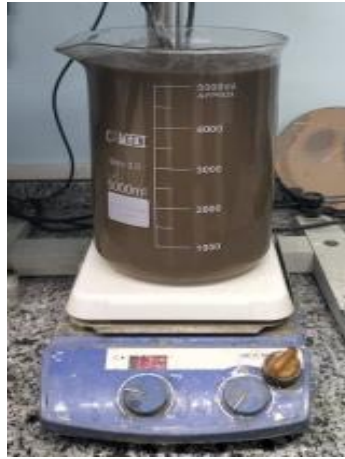
Şekil 4.143. 532 gr H_2SO_4 ilavesi sonrası liç çözeltisi, pH:3,0.
