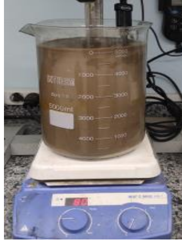
Şekil 4.83. 229,61 gr H 2 SO 4 ilavesi sonrası liç çözeltisi, pH:6,0.
