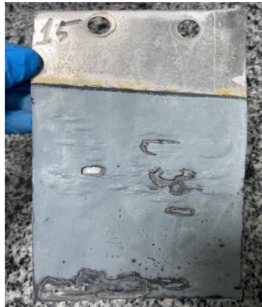
Şekil 4.148. Elektroliz sonrası Al (katot) plaka ön yüz.
