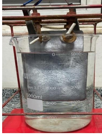
Şekil 4.107. Liç çözeltisi sıvısının elektrolizi.
