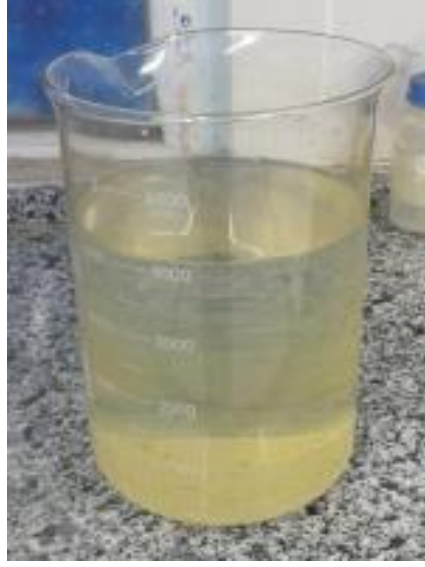
Şekil 4.76. Elektrolize hazır liç çözeltisi sıvısı.
