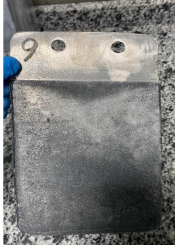
Şekil 4.89. Elektroliz sonrası Al (katot) plaka arka yüz.
