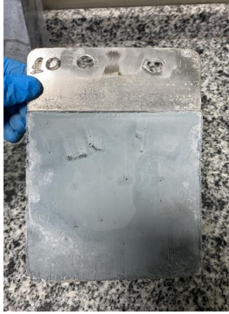
Şekil 4.98. Elektroliz sonrası Al (katot) plaka ön yüz.
