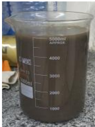
Şekil 4.144. Liç çözeltisi dinlenmeye alınma uygulaması.
