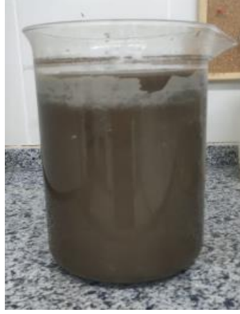
Şekil 4.94. Liç çözeltisi dinlenmeye alınma uygulaması
