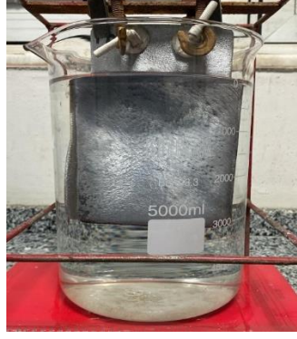
Şekil 4.167. Liç çözeltisi sıvısının elektrolizi.
