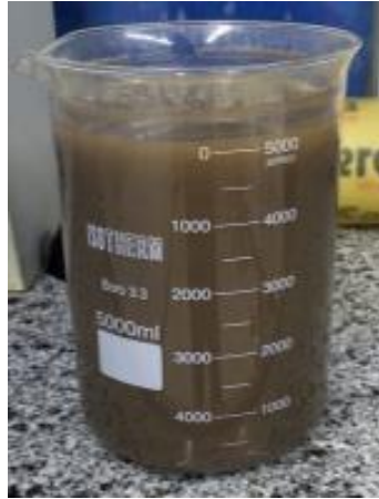
Şekil 4.164. Liç çözeltisi dinlenmeye alınma uygulaması.
