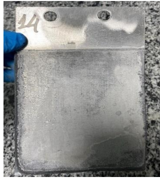
Şekil 4.139. Elektroliz sonrası Al (katot) plaka arka yüzü.
