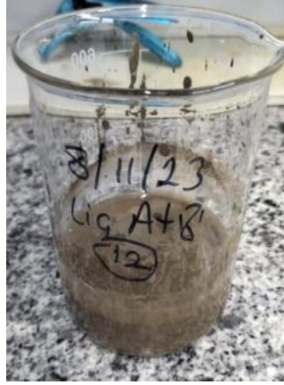
Şekil 4.115. Dinlendirilen liç çözeltisi yağsız vakum pompası yardımı ile süzülen liç atığı.
