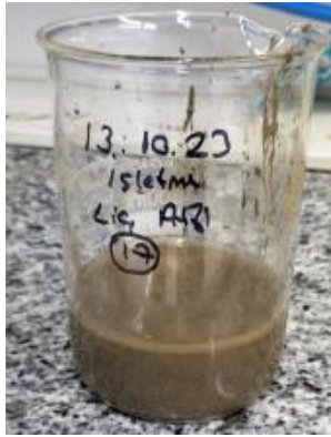
Şekil 4.165. Dinlendirilen liç çözeltilisi yağsız vakum pompası yardımı ile süzülen liç atığı.
