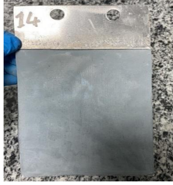
Şekil 4.138. Elektroliz sonrası Al (katot) plaka ön yüzü.
