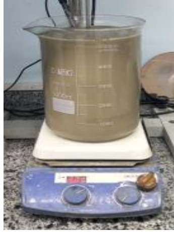
Şekil 4.142. 500 gr ürün ilavesi sonrası liç çözeltisi, pH: 10,36.
