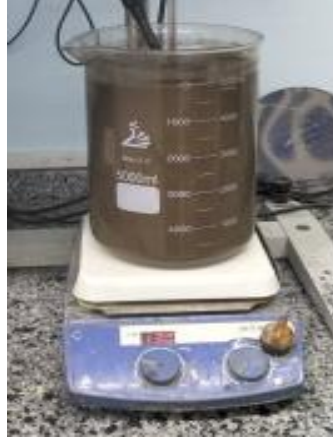
Şekil 4.103. 518,50 gr H 2 SO 4 ilavesi sonrası liç çözeltisi, pH:5,0.
