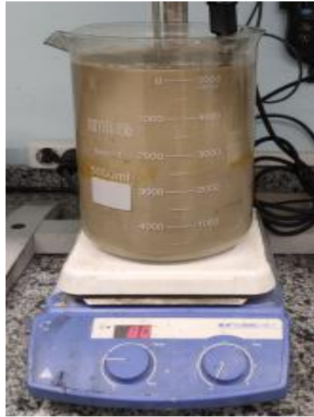
Şekil 4.82. 500 gr ürün ilavesi sonrası liç çözeltisi, pH: 10,36.
