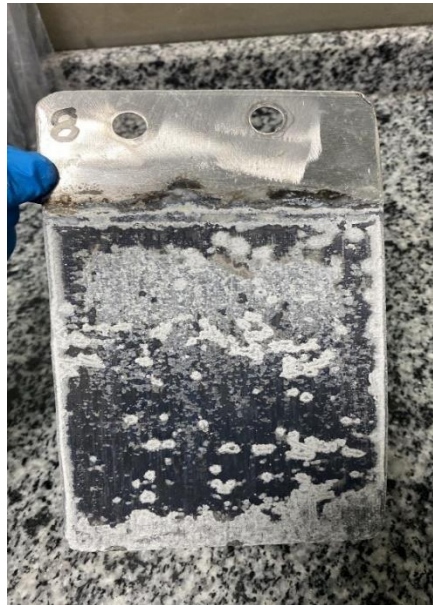
Şekil 4.79. Elektroliz sonrası Al (katot) plaka arka yüz.
