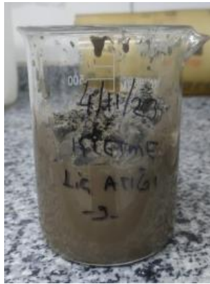
Şekil 4.85. Dinlendirilen liç çözeltisi yağsız vakum pompası yardımı ile süzülen liç atığı.
