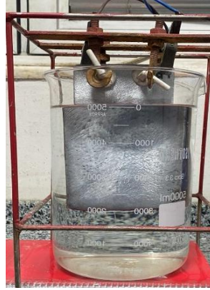
Şekil 4.127. Liç çözeltisi sıvısının elektrolizi.
