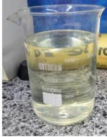
Şekil 4.176. Elektrolize hazır liç çözeltisi sıvısı.
