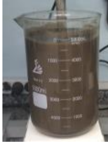
Şekil 4.104. Liç çözeltisi dinlenmeye alınma uygulaması.
