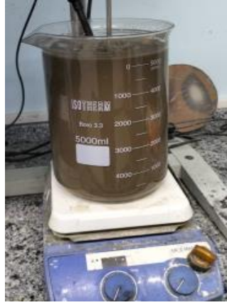
Şekil 4.163. 734,04 gr H 2 SO 4 ilavesi sonrası liç çözeltisi, pH:2,0.
