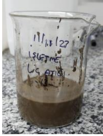
Şekil 4.125. Dinlendirilen liç çözeltisi yağsız vakum pompası yardımı ile süzülen liç atığı.
