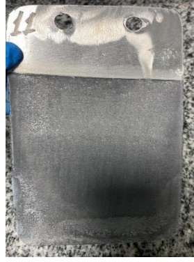
Şekil 4.109. Elektroliz sonrası Al (katot) plaka arka yüz.
