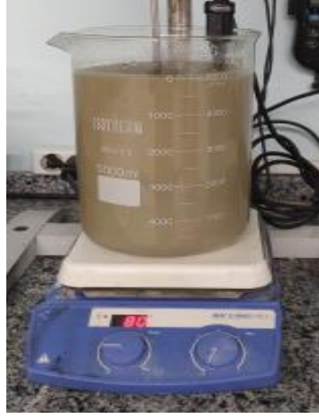
Şekil 4.52. 500 gr ürün ilavesi sonrası liç çözeltisi, pH: 10,36.
