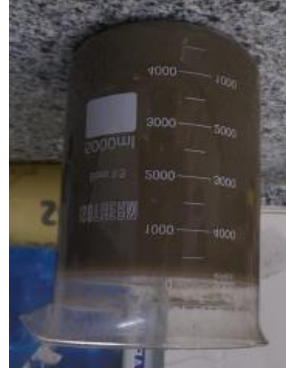
Şekil 4.154. Liç çözeltisi dinlenmeye alınma uygulaması.
