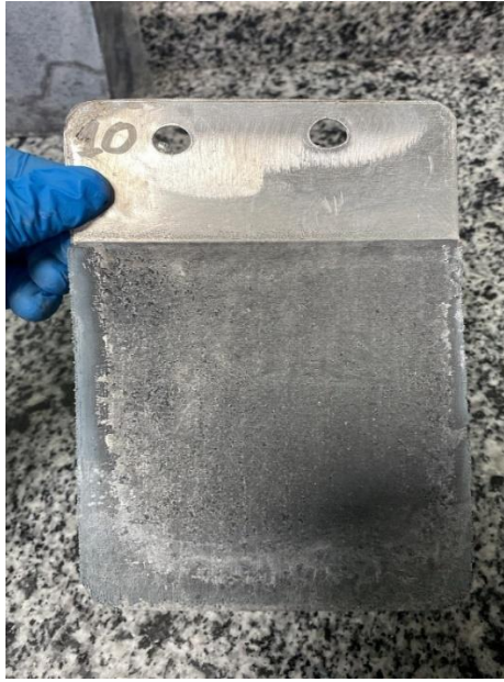
Şekil 4.99. Elektroliz sonrası Al (katot) plaka arka yüz.
