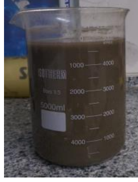
Şekil 4.153. 561,28 gr H 2 SO 4 ilavesi sonrası liç çözeltisi, pH:2,5.
