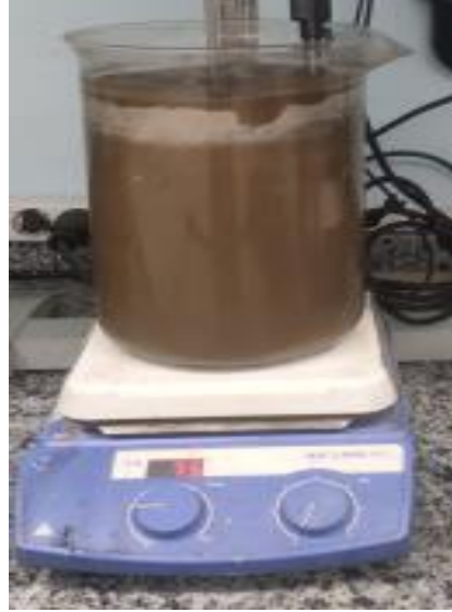
Şekil 4.93. 414,95 gr H 2 SO 4 ilavesi sonrası liç çözeltisi, pH:5,5.
