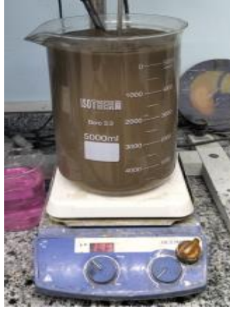
Şekil 4.173. 909,14 gr H_2SO_4 ilavesi sonrası liç çözeltisi, pH:1,5.
