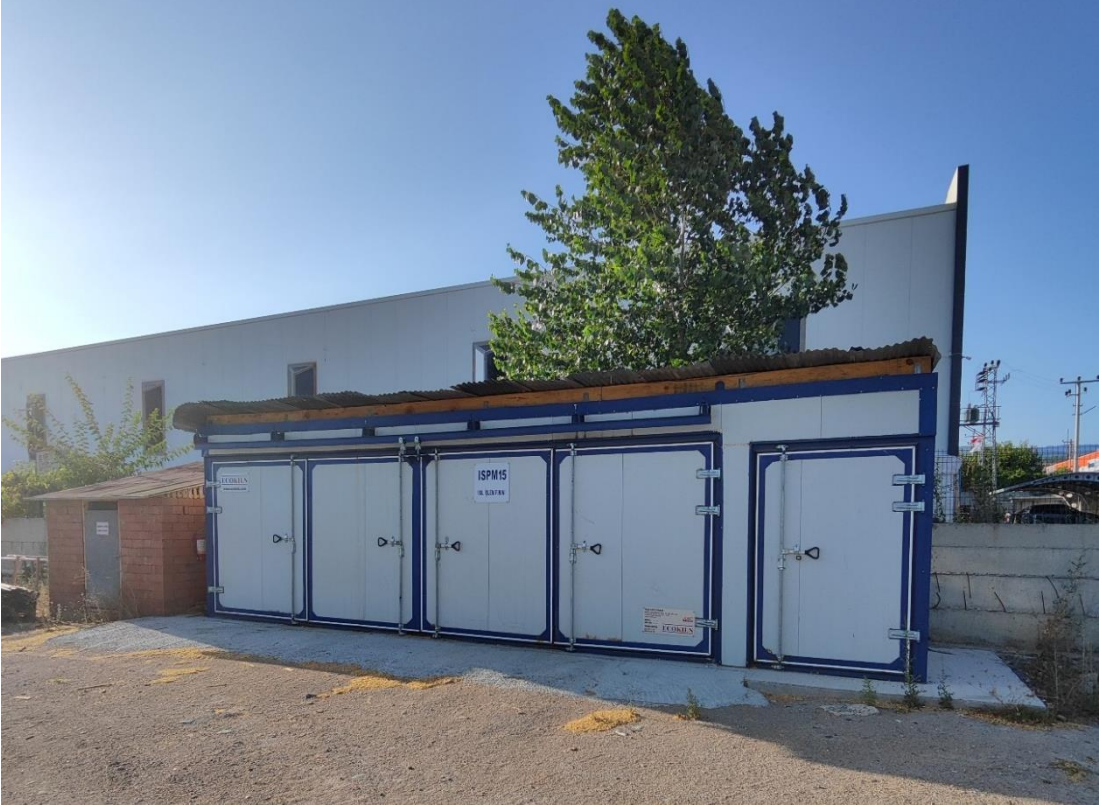
Fotoğraf 8: Orman Ürünleri Üretiminde Faaliyet Gösteren Bir Firmaya Ait Isıl İşlem Fırını
