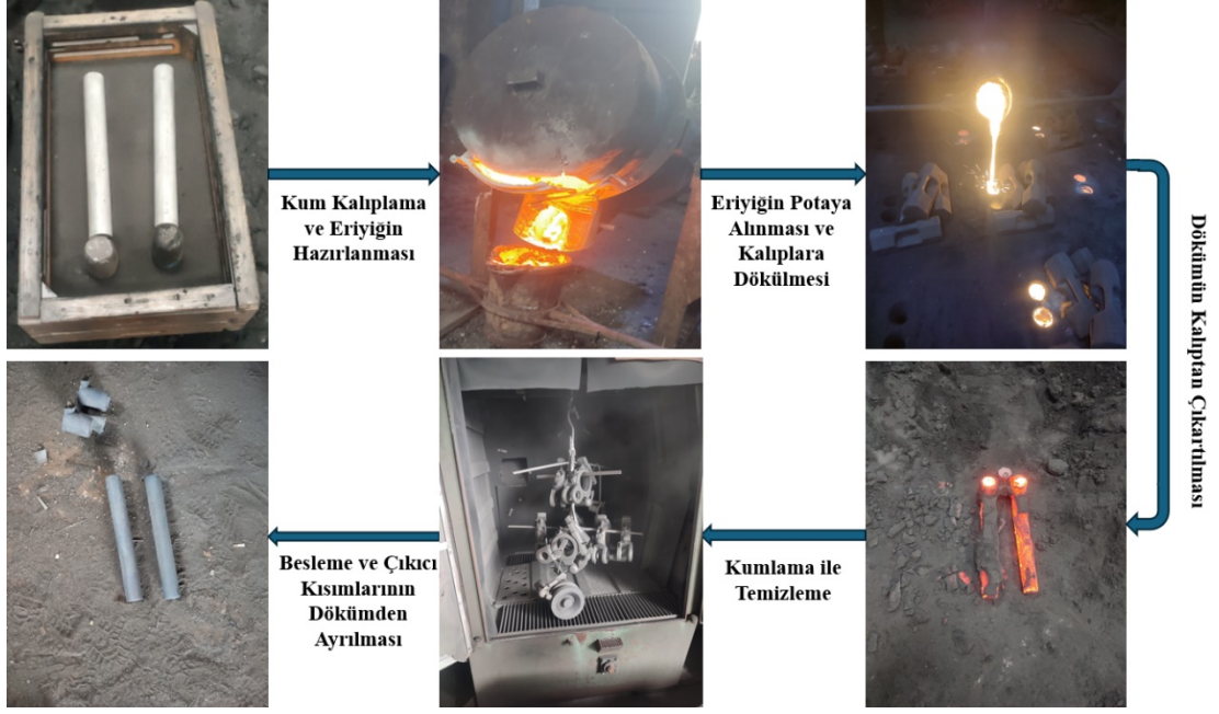
Şekil 4.1. Döküm çubukların üretim aşamaları.
