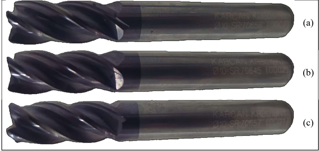
Şekil 4.5. Deneyde kullanılan parmak frezelerin gerçek görseli; a) 35°, b) 38°, c) 35/38°.
