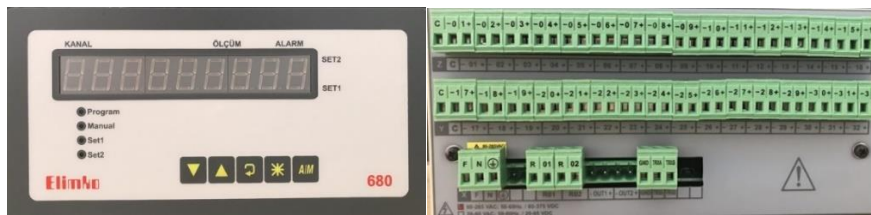
Şekil 3.6. Kullanılan E-680 tarayıcı cihazı.
