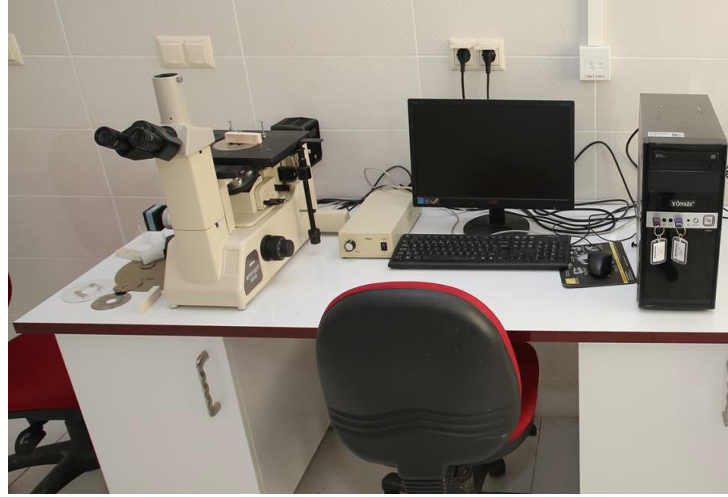
Şekil 4.22. Metalografik incelemelerde kullanılan Nikon Epiphot 200 marka optik mikroskop.
