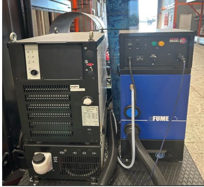
Şekil 4.2. EWM marka Phoenix 452 Puls MM RC gazaltı kaynak makinesi (soldaki) ve Abicor Binzel marka xFume model duman emme sistemi (sağdaki).
