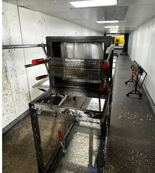
Şekil 4.27. Hedef sehpasına bağlanmış numune plakaya lazer ile nişan alınması.
