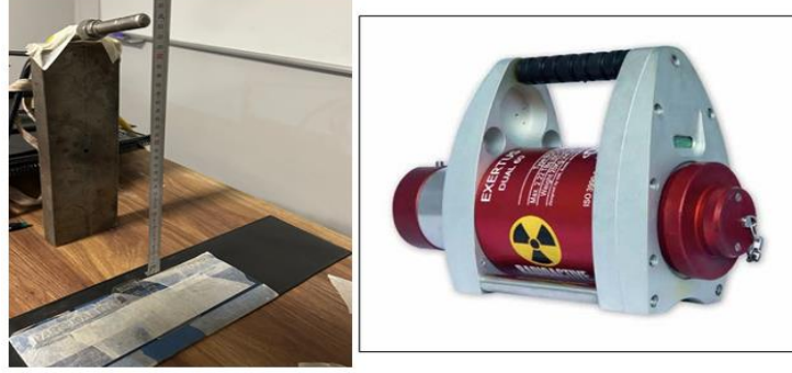
Şekil 4.15. Radyografik muayene yöntemi ve testte kullanılan gama radyografi cihazı (Exertus Dual 120).
