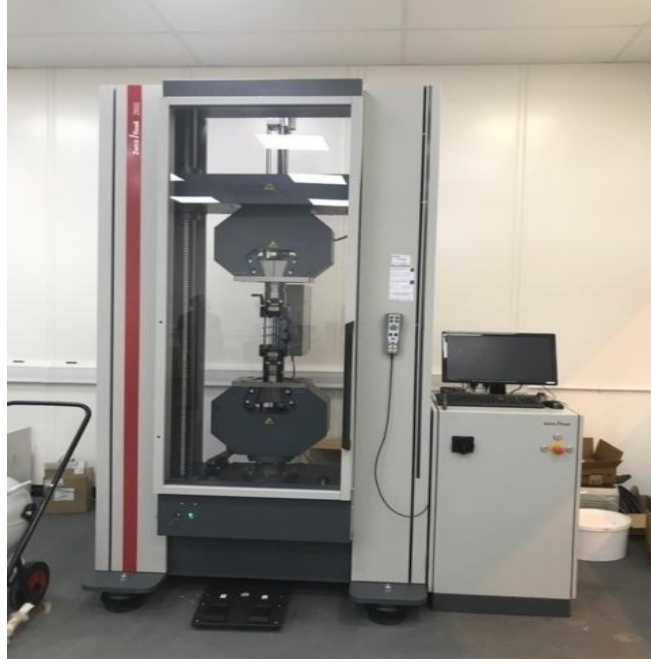
Şekil 4.19. Zwick/Roell Z600 model 600 kN kapasiteli eğme test cihazı.
