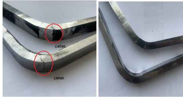
Şekil 5.26. Kaynak sonrası ısıl işlem uygulanmış Bisalloy HHA 500 zırh çeliğine ait eğme testi sonucu çatlama bölgesi.
