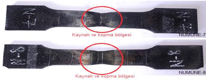
Şekil 5.9. Kaynak sonrası ısıtıl işlem uygulanmış Bisalloy HHA 500 zırh çeliği kaynaklı birleştirmelerine ait çekme testi sonucunda oluşan kopma bölgesi.
