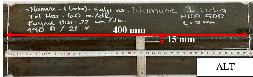
Şekil 4.12. Plaka-1 (Bisalloy HHA 500-Bisalloy HHA 500) kaynak (alt).
