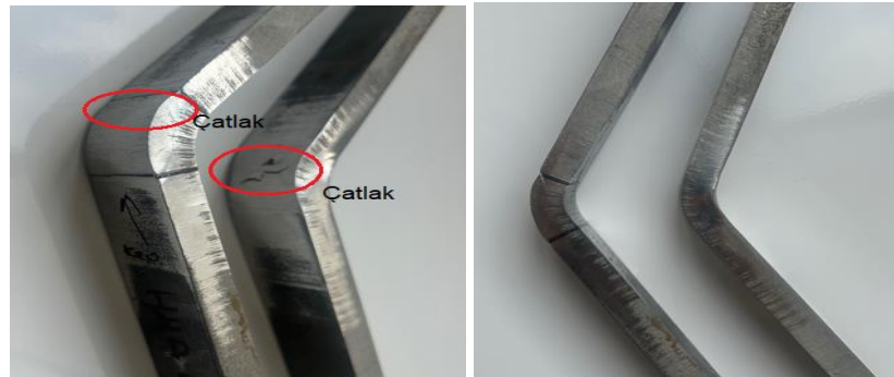
Şekil 5.24. Bisalloy HHA 500 zırh çeliği kaynaklı birleştirme numunelerine ait eğme testi sonucu çatlama bölgesi.
