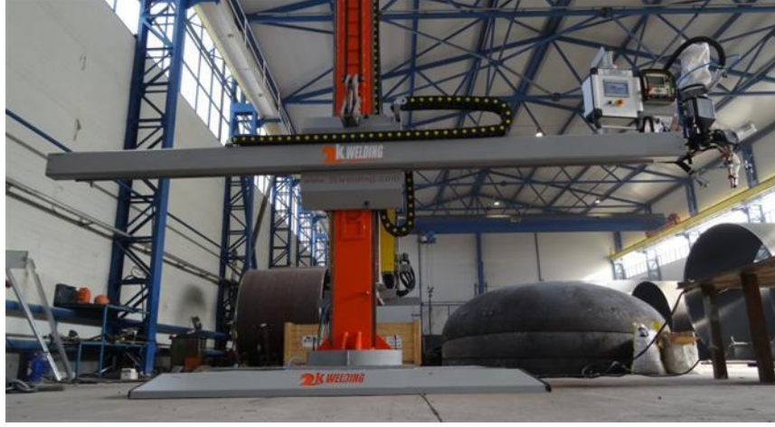
Şekil 4.1. 2k Welding firmasına ait kolon-bom sistemli otomatize edilmiş kaynak makinesi.
