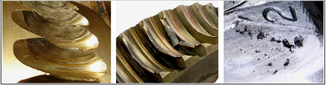
Şekil 5. 11. Zedelenmiş karşılık dişli görüntüsü [44].
