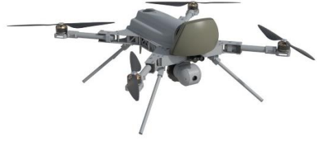
Şekil 1.1.b. Döner kanatlı İHA.
