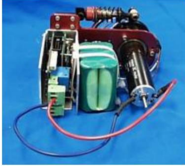
Şekil 2.7. Genbu yılan robotun iç yapısı [16].
