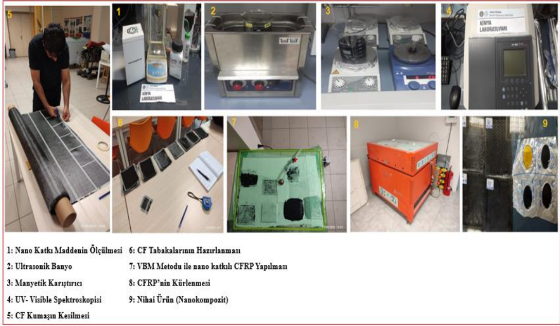
Şekil 4.5. Nanokompozitlerin üretim aşamaları.
